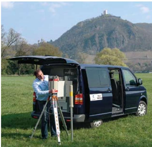
Mobile In-situ-Messung an einer ODL-Messstelle
