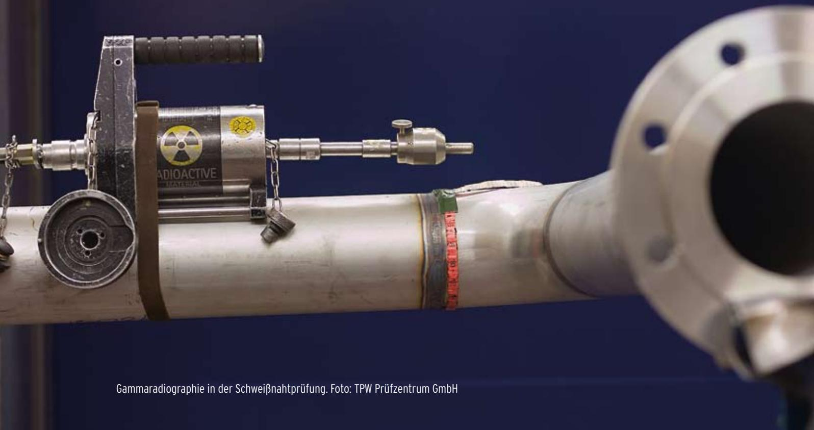
Gammarradiographie in der Schweißnahtprüfung. Foto: TPW Prüfzentrum GmbH
