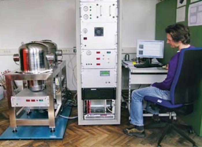
Das nuklidspezifische Xenon-Messsystem "SAUNA II Lab" im BFS-Edelgas-Laboratorium
