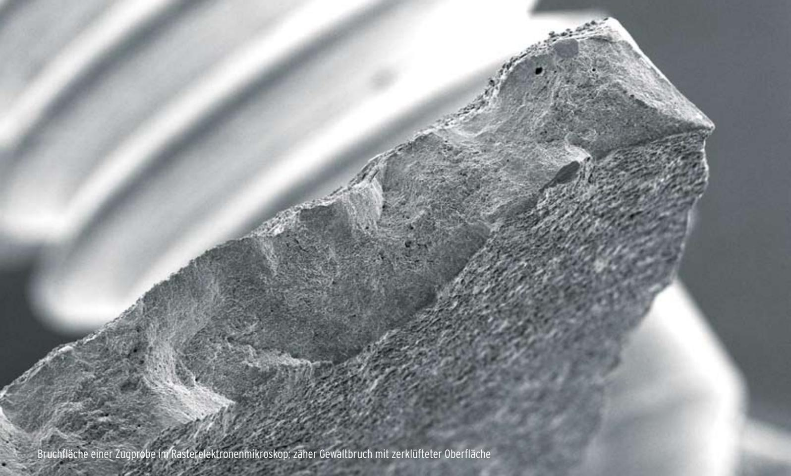
Bruchfläche einer Zugprobe im Rasterelektronenmikroskop; zäher Gewaltbruch mit zerklüfteter Oberfläche
