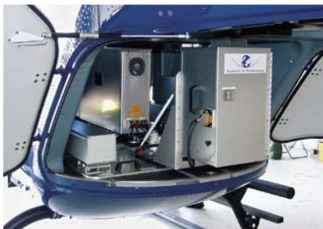
Messsystem des BfS im Heckteil des Hubschraubers
