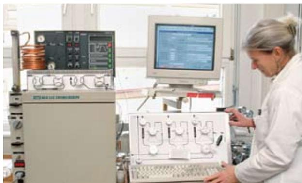
Messapparatur zur Bestimmung der Kr-85-Aktivität in Luftproben
