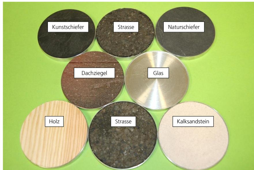
**Abb. 3.4:** Testoberflächen für die Resuspensionsmessungen im Strömungskanal.
