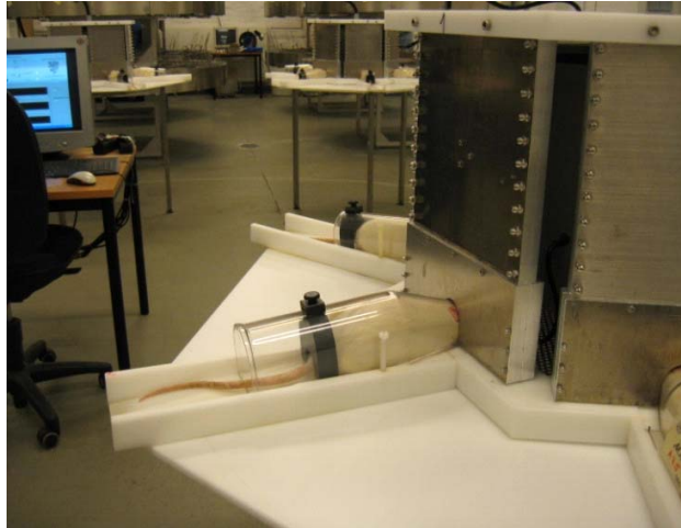
Abbildung 1: Expositionsanlage mit 6 Steckplätzen; im Restraint fixierte Ratte während der Exposition
