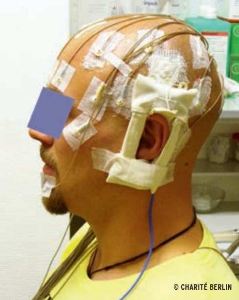
Testperson mit am Kopf aufgeklebten EEG-Elektroden und der am linken Ohr befestigten Flachantenne zur Exposition
