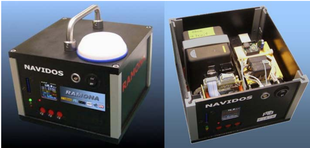
Abbildung 6. Linkes Bild: Das in zwei Airbus A340 der DLH installierte NAVIDOS (Größe: 17 cm × 17 cm × 12 cm). Auf der Vorderseite sind OLED Bildschirm, Tastschalter und die Steckbuchse für die externe Stromversorgung zu sehen. Die GPS-Antenne ist auf dem Deckel des Gehäuses angebracht. Rechtes Bild: Blick in das offene NAVIDOS mit dem DOSTEL (links hinten), dem Datenlogger und der Stromversorgung (links hinter dem OLED Bildschirm). Die Batterie für autarken Messbetrieb ist auf der rechten Seite untergebracht.
