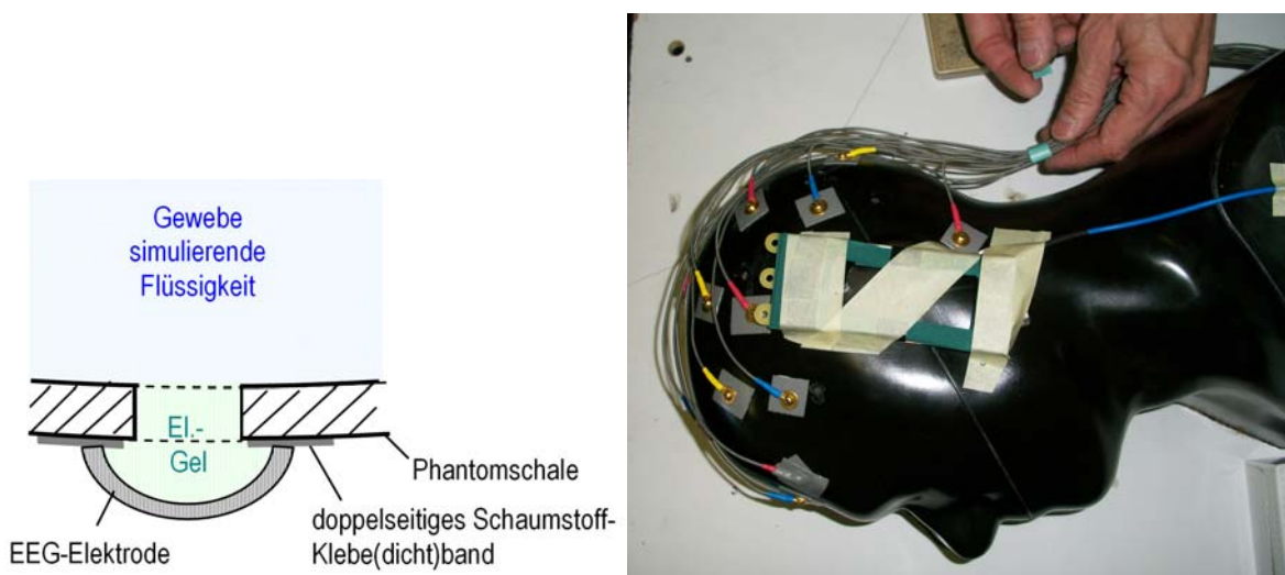
Abb. 22: Schema der Elektrodenbefestigung am Phantom (links) und Ansicht des fertig für die Messungen vorbereiteten Phantoms (rechts)
