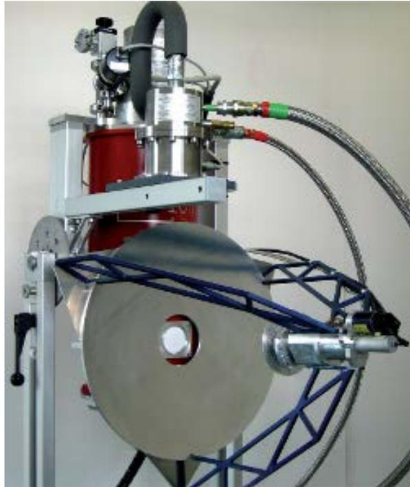
Abbildung 13: Prototyp einer passiven THz-Kamera bestehend aus einem Cassegrain Teleskopsystem mit einem 50 cm-Hauptspiegel und einem in zwei Achsen verkippbaren 12 cm-Sekundärspiegel und einem integrierten Cryogen-freien Kühlsystem [58].
