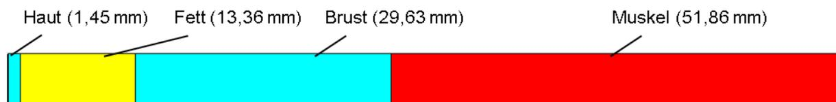
Abbildung 201: Für die Temperaturberechnung verwendete Materialschichtung aus dem Brustbereich
