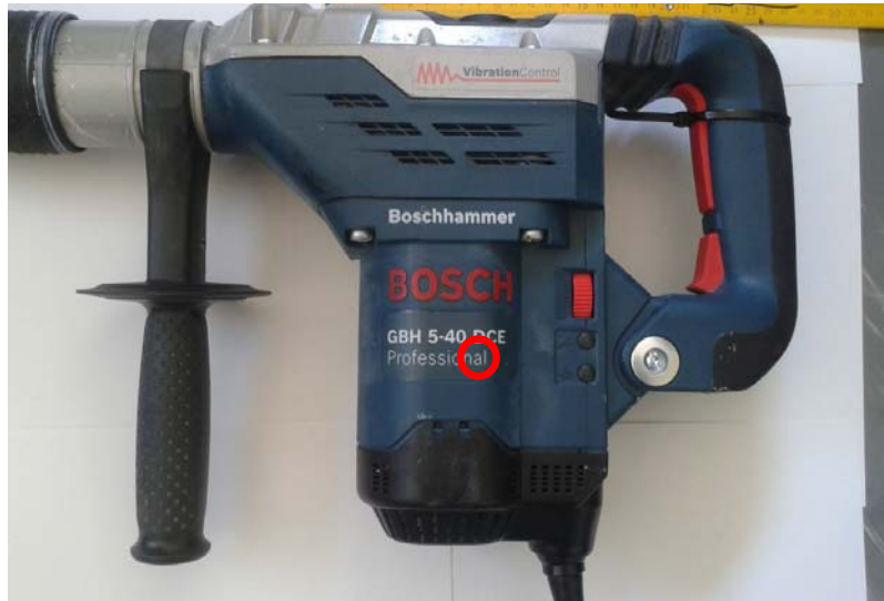
Abbildung 5.3: Position des Maximum der magnetischen Feldstärke (roter Kreis)
