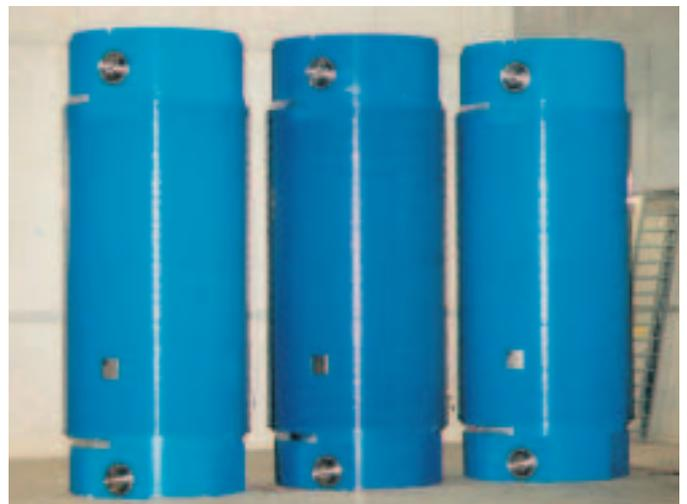
Transport- und Lagerbehälter der Bauart CASTOR V/19
