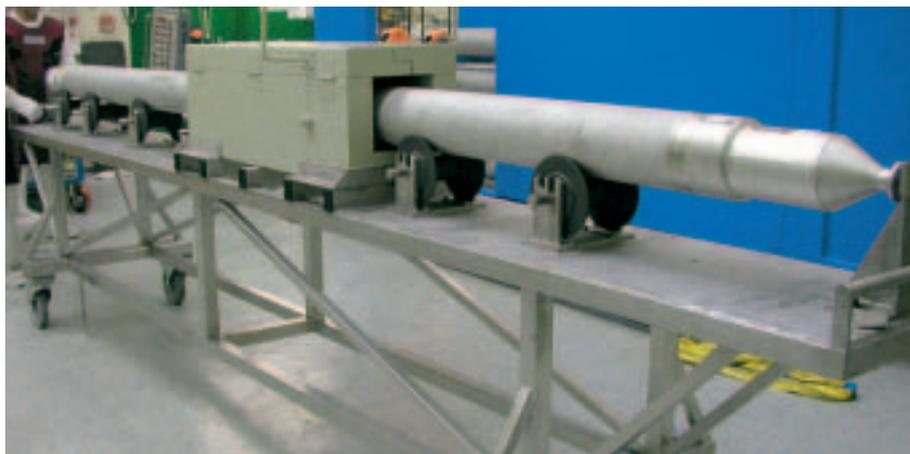
*Transportwagen mit einem SNR- Brennelement, verpackt in einem Einzel-SNR-Brennelemente-Behälter (ESBB)*
