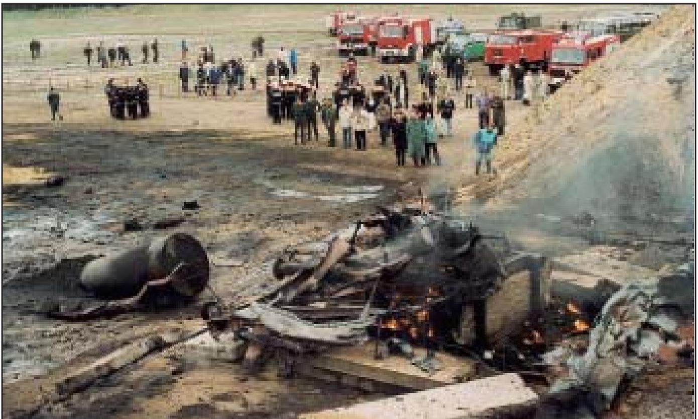
Versuchsstand nach der Explosion des Eisenbahnkesselwagens. Der Transportbehälter wurde aus seiner Auflage gerissen und durch die Luft geschleudert. Die Schutzwirkung blieb erhalten (Quelle: BAM).
