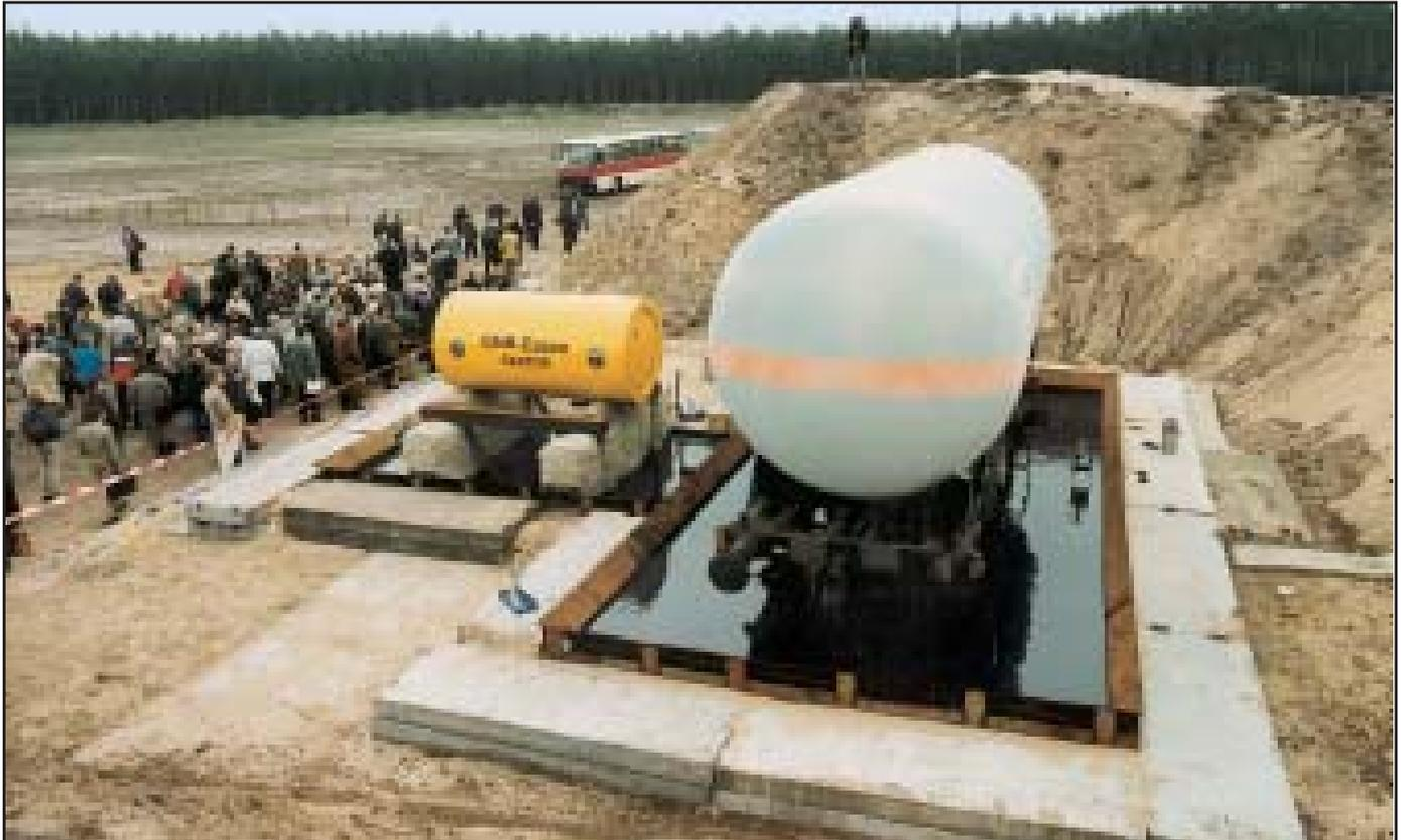
Großbrandversuch mit einem gasgefüllten Eisenbahnkesselwagen und einem Transportbehälter für radioaktives Material auf dem Versuchsgelände der BAM (Quelle: BAM).
