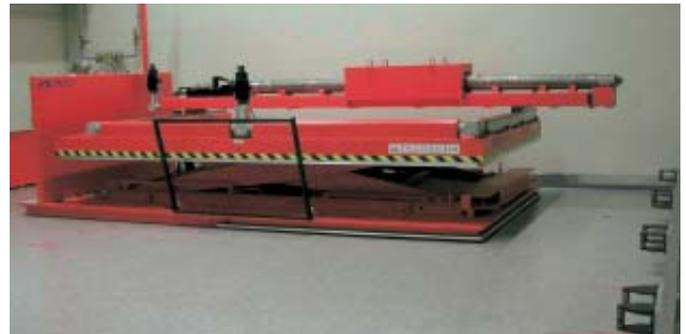
Ein auf Luftkissen zu bewegendes Scherenhubwagen zur Einlagerung von Einzel-SNR-Brennelemente-Behältern (ESBB)
