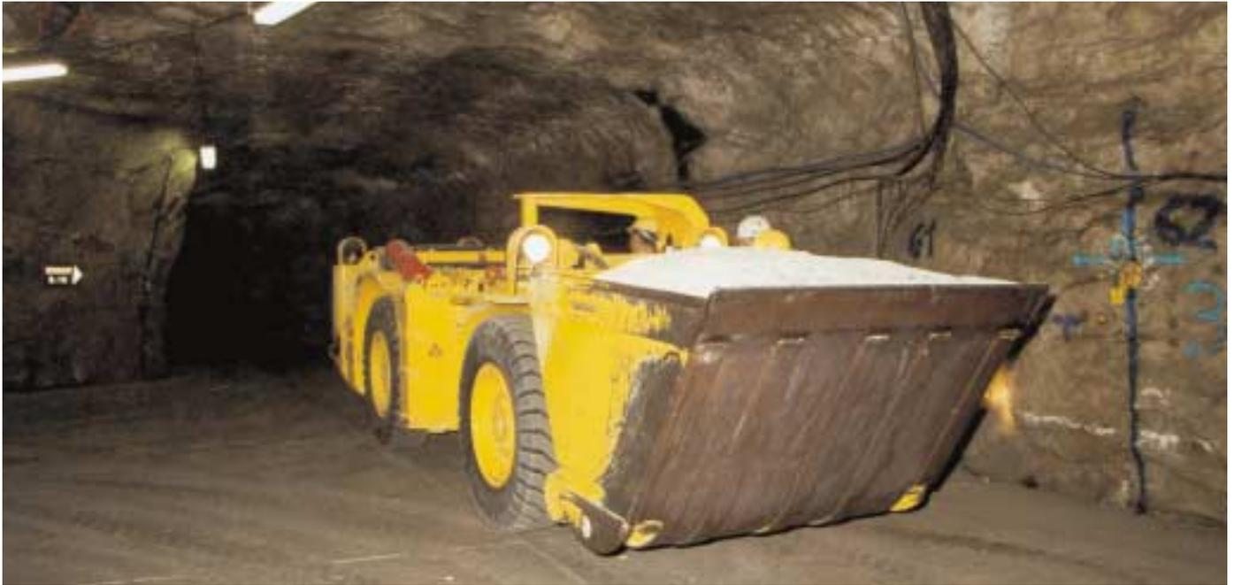
Salzgrustransport mit Fahrladern zur Verfüllung der Einlagerungskammern im Südfeld des ERAM
