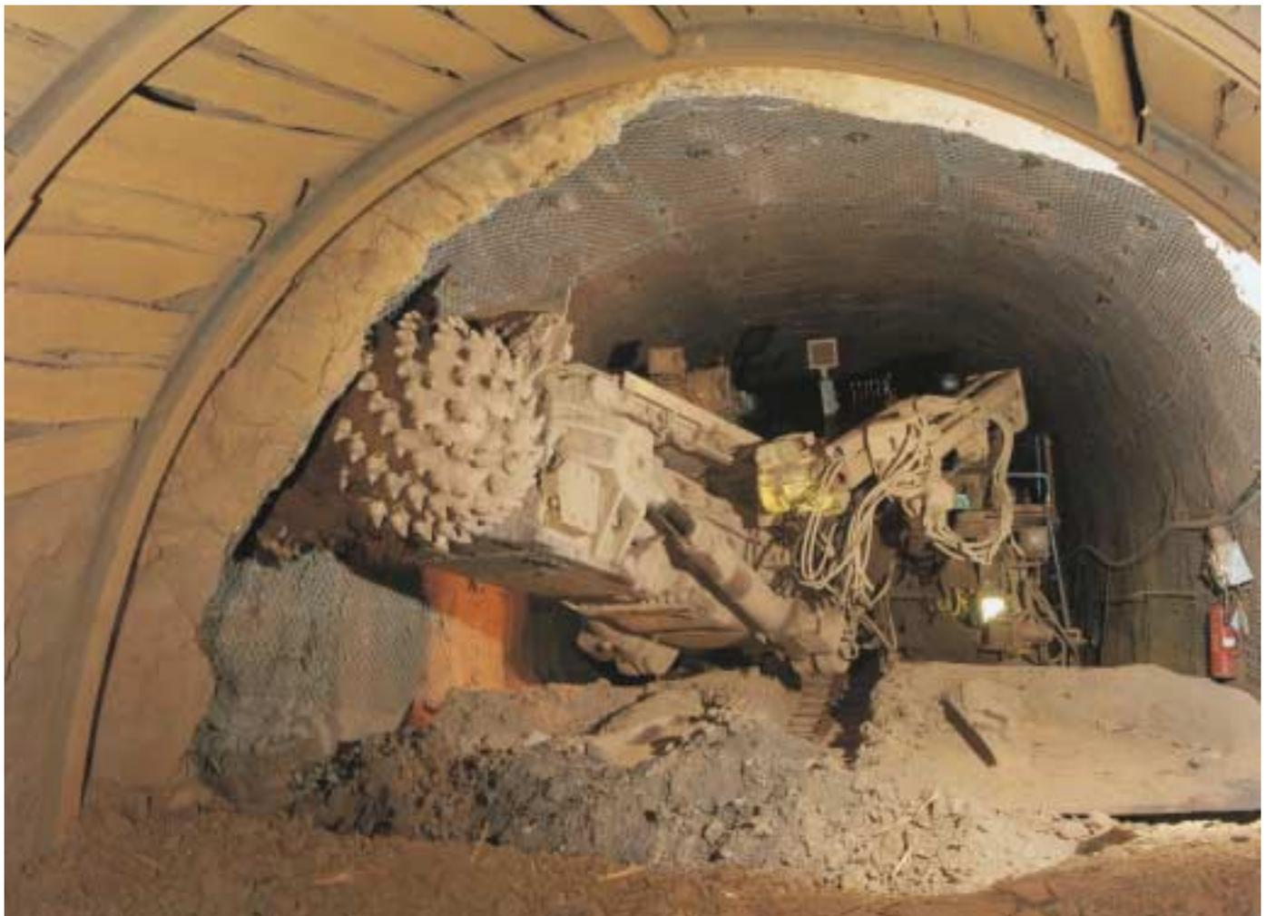
Die Teilschnittmaschine WAV-300 bei der Streckensicherung in Schacht Konrad
