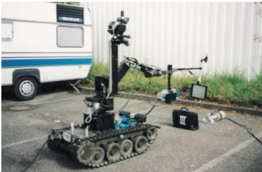
*Untersuchung einer Aktentasche mit Manipulatorfahrzeug und adaptiertem Röntgengerät*
