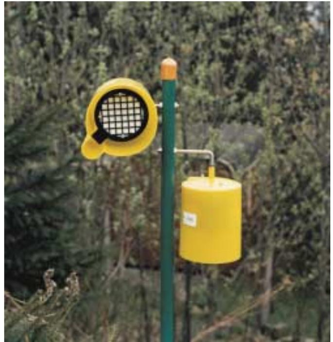
*Messeinrichtung zur Ermittlung der Radonkonzentration in der Luft*
