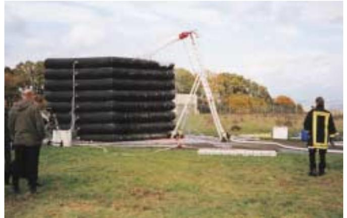
*Schaumgefüllte Einhausung zur Minimierung der Verbreitung radioaktiver Stoffe in die Luft nach dem Umsetzen von Sprengstoff*
