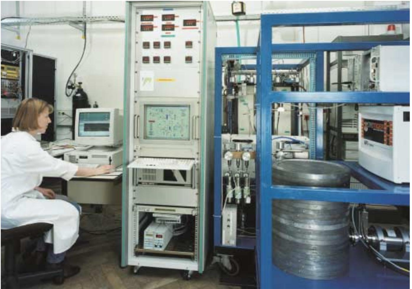
Das von CEA-DASE entwickelte französische Xenonmesssystem SPALAX (Système de Prélèvement Atmosphérique en Ligne avec l'Analyse du Xénon). Links ist im Hintergrund ein Teil des U.S.-amerikanischen Systems ARSA zu erkennen.
