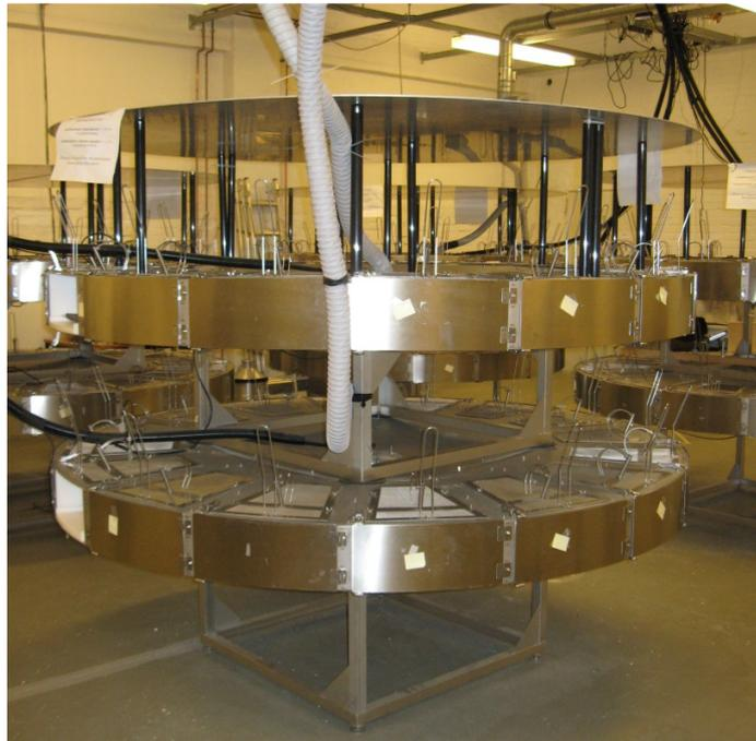
Abb. 1: Eine von vier identischen Anlagen mit zwei radialen Wellenleitungen zur UMTS-Exposition. Pro Wellenleitung stehen 16 Käfigplätze zur Exposition zu Verfügung.
