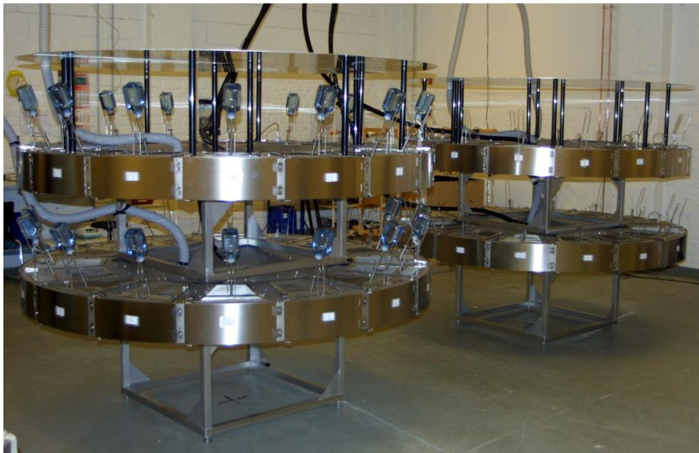
Abbildung 1: Vier der insgesamt acht radialen Wellenleitungen zur UMTS-Exposition. Jede Leitung mit 2,2 m Durchmesser und ca. 17 cm Höhe enthält 16 Käfigplätze.
