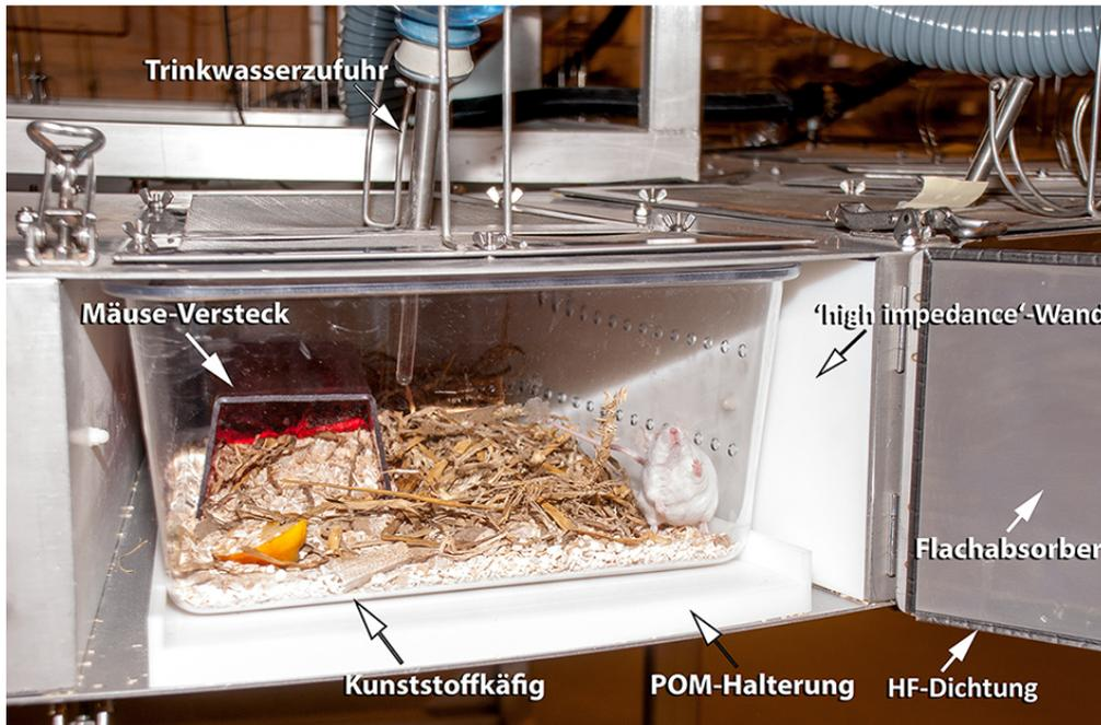
Abbildung 2: Geöffnete Klappe mit HF-Dichtung als Zugang zum Käfigbereich.
