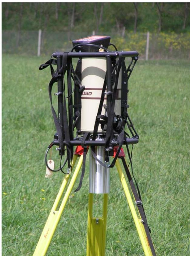
**Abbildung 1:** Großvolumiger In-situ-Detektor mit Stickstoff-Dewar, Tragevorrichtung und Stativ
