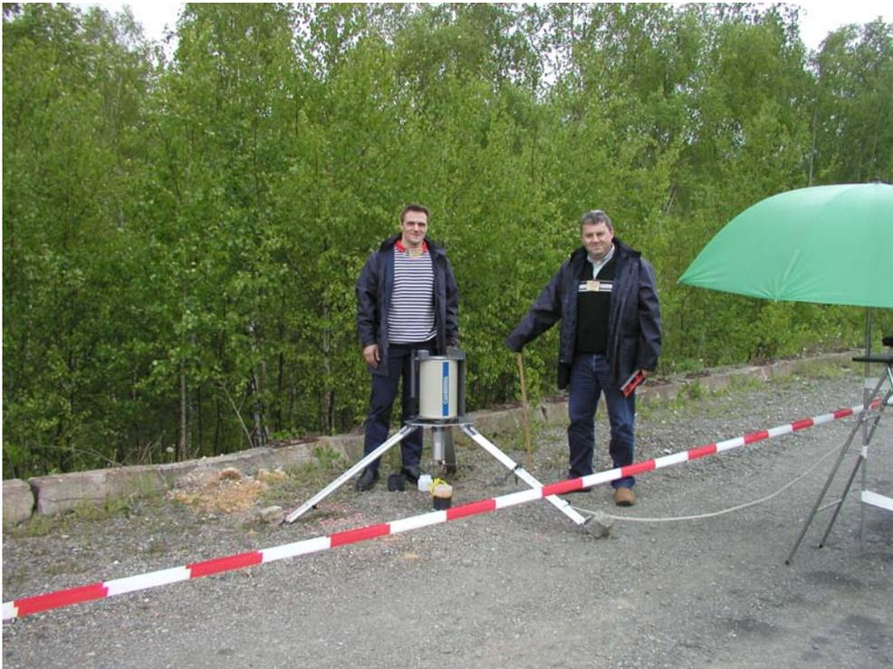
**Abbildung 12:** Bestimmung der Aktivität „vergrabener“ Quellen durch Messungen in unterschiedlichem Abstand über der Bodenoberfläche
