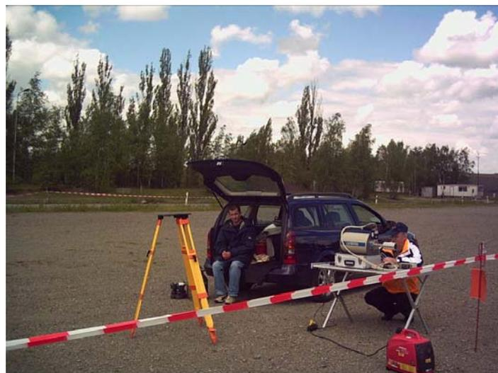
**Abbildung 13:** Bestimmung der Aktivität von radioaktiven Punktquellen durch Messung in Richtung der Kristallsymmetrieachse des Detektors
