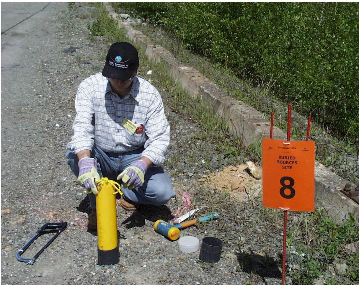
**Abbildung 11:** Einbringung der „Vergrabenen Quellen“ am Messort Reust B. Die Quellen befinden sich in dem gelben, mit Sand gefüllten Kunststoffrohr
