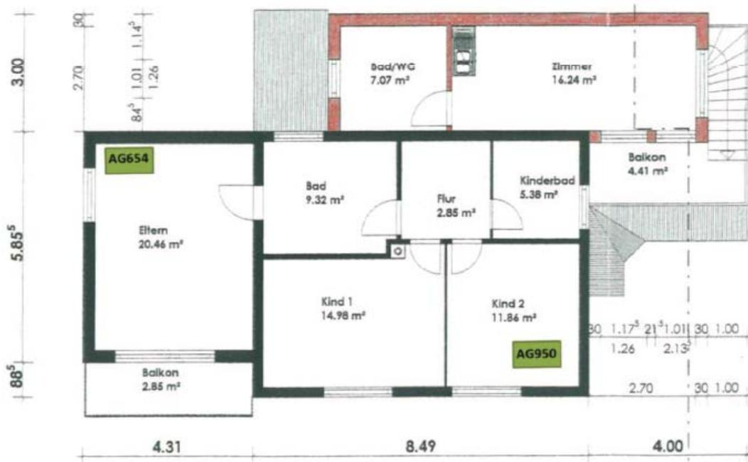
Abbildung 9: Grundriss des Obergeschosses von Messobjekt 1.
