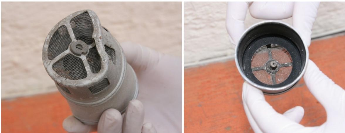
Die zylindrischen und mit korbähnlichem Aufsatz versehenen Fundstücke aus Aluminium hatten einen Durchmesser von ca. 6,5 cm und eine Länge von ca. 9,5 cm. Bei einem der Rauchmelder war nur noch eine der beiden Quellen vorhanden.
