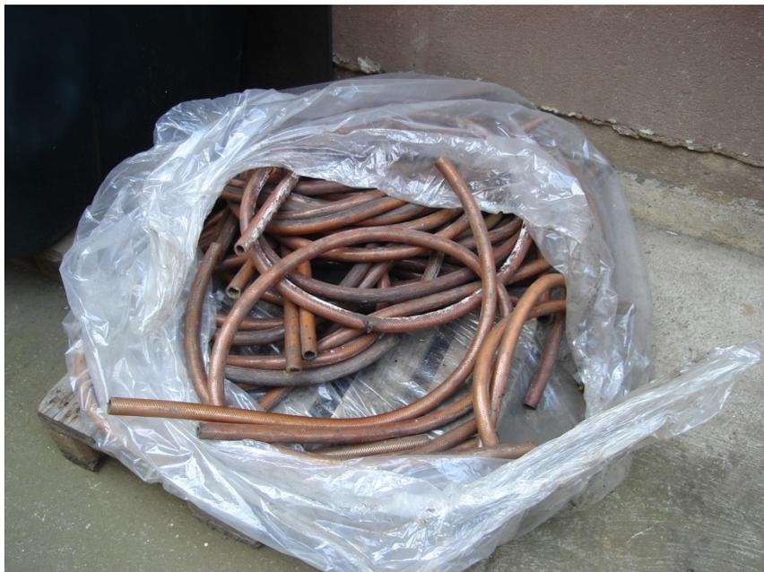
Die Vor-Ort-Messungen mit dem Oberflächenkontaminationsmonitor CoMo 170 ergaben einen deutlichen Hinweis auf das Vorhandensein von Alpha- und Beta-Strahlung (ca. 350 Ips, bei ca. 31 Ips Nulleffekt). Es wurde sowohl mit den beiden Messgeräten AD6 und InSpector 1000 an den Schlauchstücken eine maximale Dosisleistung von 2,4  $\mu\text{Sv/h}$  ermittelt (Nulleffekt ca. 0,1  $\mu\text{Sv/h}$ ).
