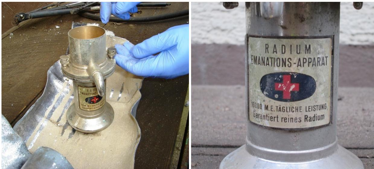
Dosisleistungsmessungen am Fundstück ergaben an der Außenseite in Kontakt eine Dosisleistung von max. 120  $\mu\text{Sv/h}$ , direkt an Quelle max. 248  $\mu\text{Sv/h}$  und an der unteren Hälfte bei abgenommenem Oberteil max. 23  $\mu\text{Sv/h}$ . Messungen mit dem Kontaminationsmonitor CoMo 170 ergaben eine deutlich nachweisbare, leicht abwischbare Kontamination, sowie das Vorhandensein von Alpha- und Beta-Strahlung.
