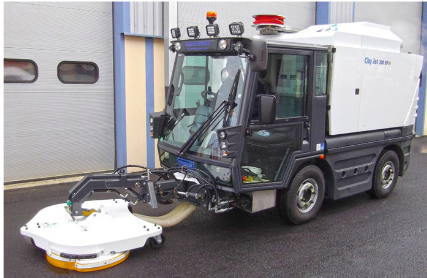
Abbildung 5.2: Schwemmfahrzeug mit 2,2 m 3 -Tank zur Straßenreinigung und Bewässerung [ASH 16]
