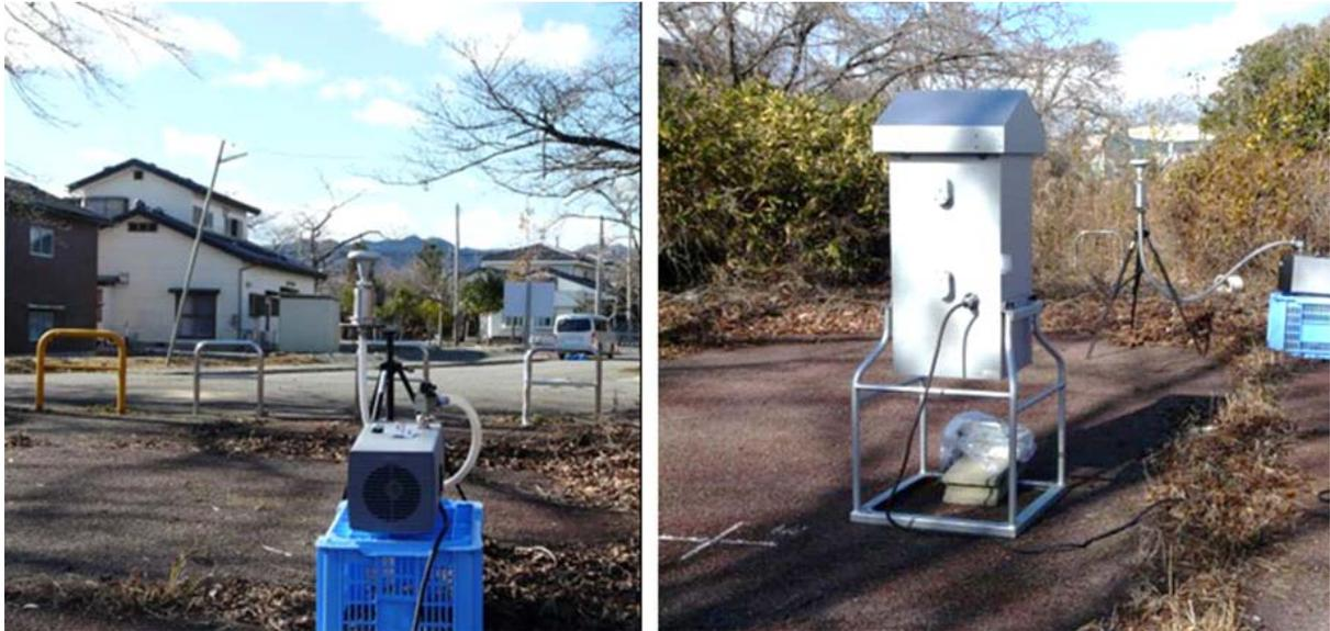
**Abbildung 2:** Kaskaden-Impaktor (LPI 30, Fa. Hauke, Gmunden) für größenfraktioniertes Sammeln (links) und HiVol-Filterstaubsammler (rechts im Vordergrund) zum Sammeln des Gesamtstaubes am Rand einer Wohnsiedlung in der Evakuierungszone von Fukushima
