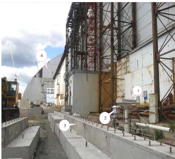
**Abbildung 1: Foto der Sammelgeräte und Sammelorte neben dem Tschernobyl-KKW. Bei 1 ist ein Filtersammler (GRAD-1.8), bei 2 ein Impaktor (Andersen PM10), bei 3 ein Teil des künftigen Fundaments und bei 4 die neue Einhausung zu sehen.**
