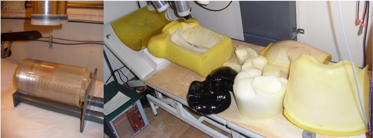
Abbildung 5: Zwei Kalibrier-Phantome für den Teilkörperzähler. Links das Halsphantom zur Kalibrierung für Schilddrüsenmessungen, rechts das LLNL-Lungenphantom (mit Organen und Overlays in zerlegtem Zustand).
