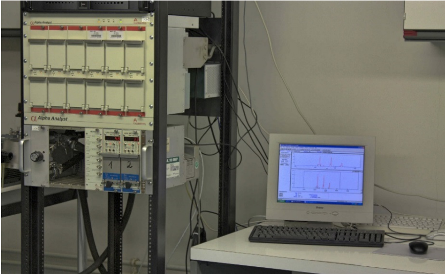
Abbildung 6: Alpha-Spektrometer mit 12 Messkammern
