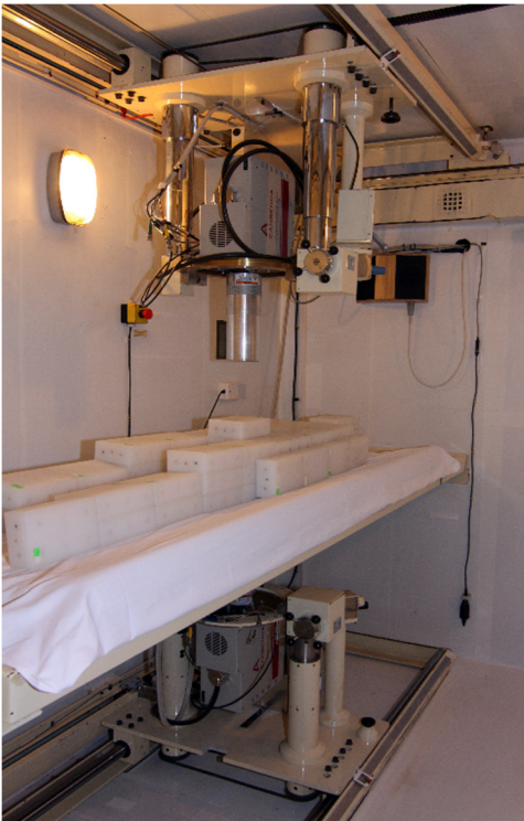
Abbildung 3a: Kalibrierphantom (70-kg-Konfiguration). Abbildung 3b: Oberer Detektor mit elektrischer Kühlung in Schilddrüsenmessgeometrie.
