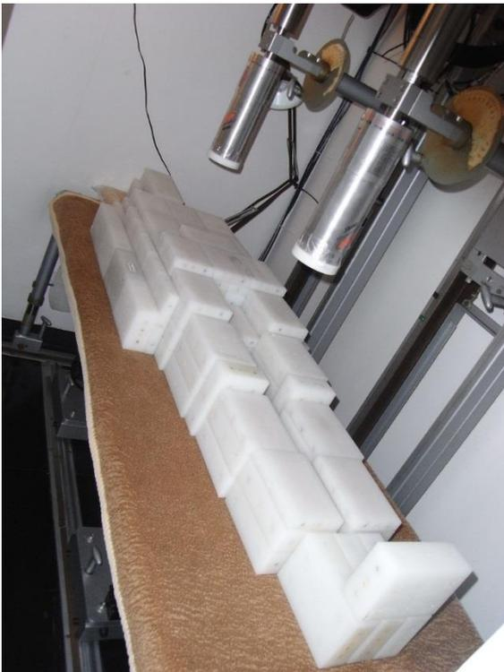
**Abb. 6: Kalibrierphantom (90-kg-Konfiguration)**
