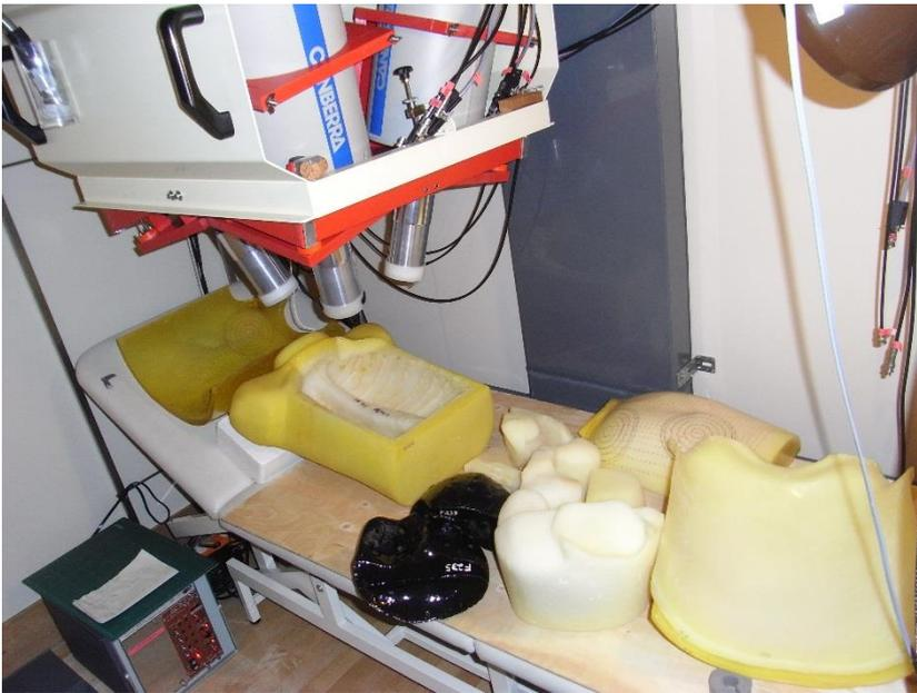
**Abb. 8:** Der Lungenzähler Neuherberg. Zu sehen sind drei der vier Reinstgermaniumdetektoren und die angeflanschten Dewar-Gefäße für den Flüssigstickstoff. Auf der Messliege befindet sich das LLNL-Lungenphantom (mit Organen und Overlays in zerlegtem Zustand).
