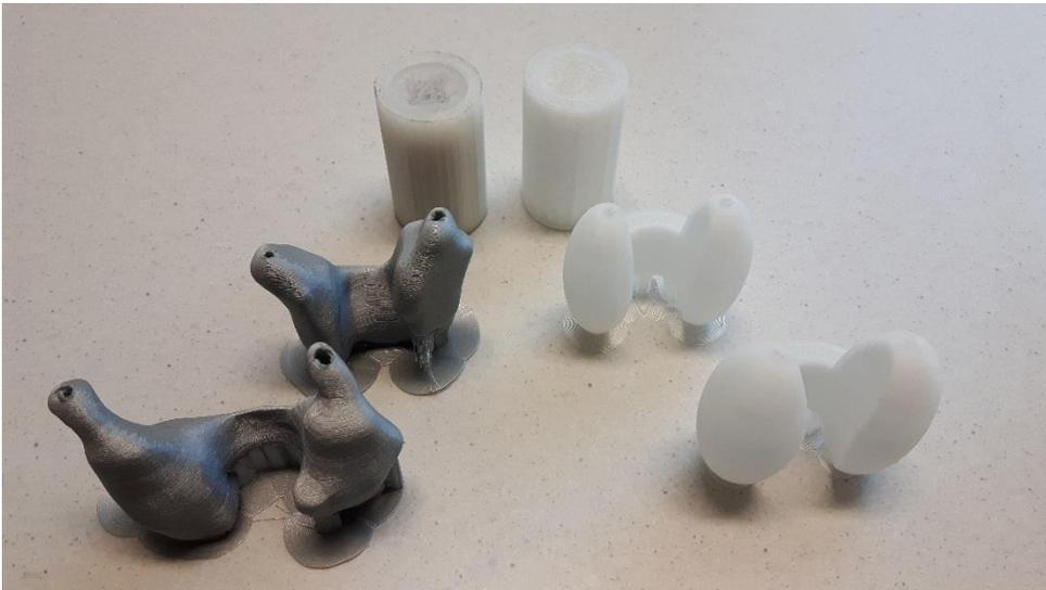
**Abb. 10:** Gedruckte Schilddrüsenquellen, links vorne: anatomische Schilddrüsen männlich und weiblich, hinten: zylinderförmige Schilddrüsen, rechts vorne: geometrisch komplexere „experimentelle“ Schilddrüsen in zwei unterschiedlichen Größen.
