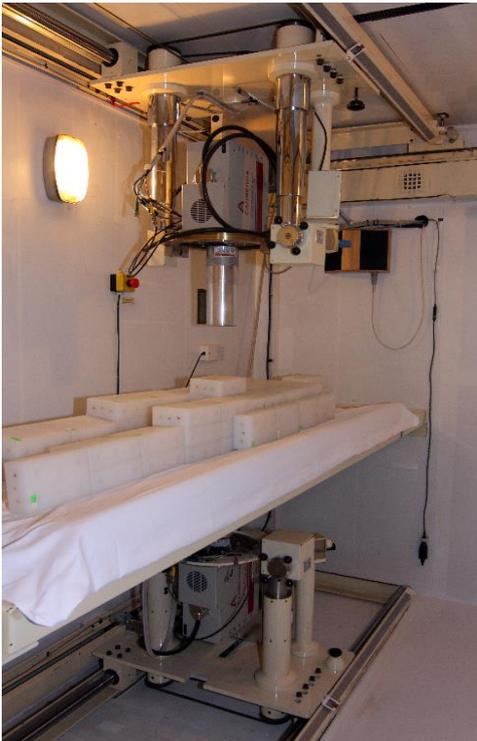
**Abbildung 3a: Kalibrierphantom (hier in einer Konfiguration einer 70-kg-Person)**
