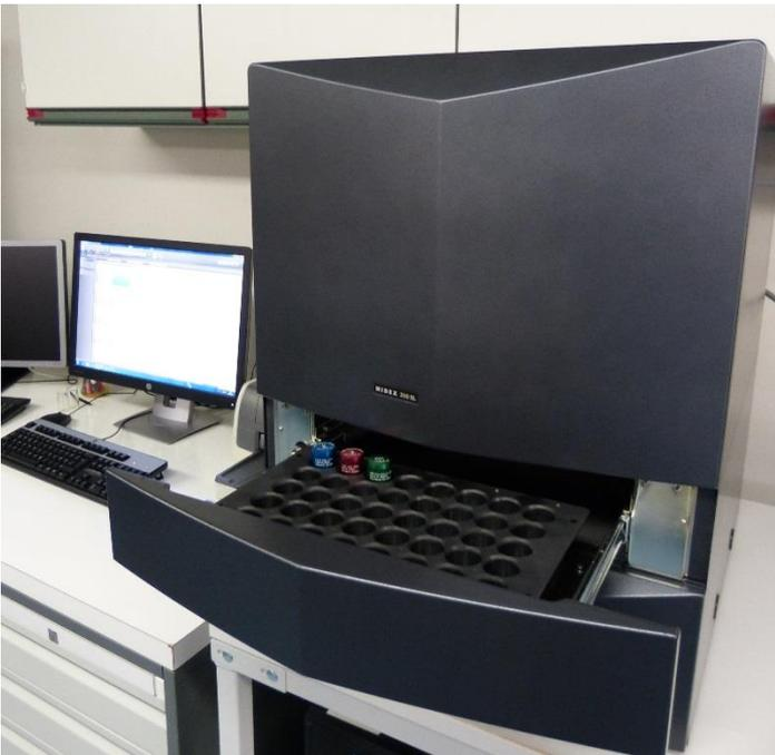
**Abbildung 7: Flüssigszintillationsspektrometer Hidex 300 SL zur Messung der Aktivitätskonzentration in Ausscheidungsproben.**
