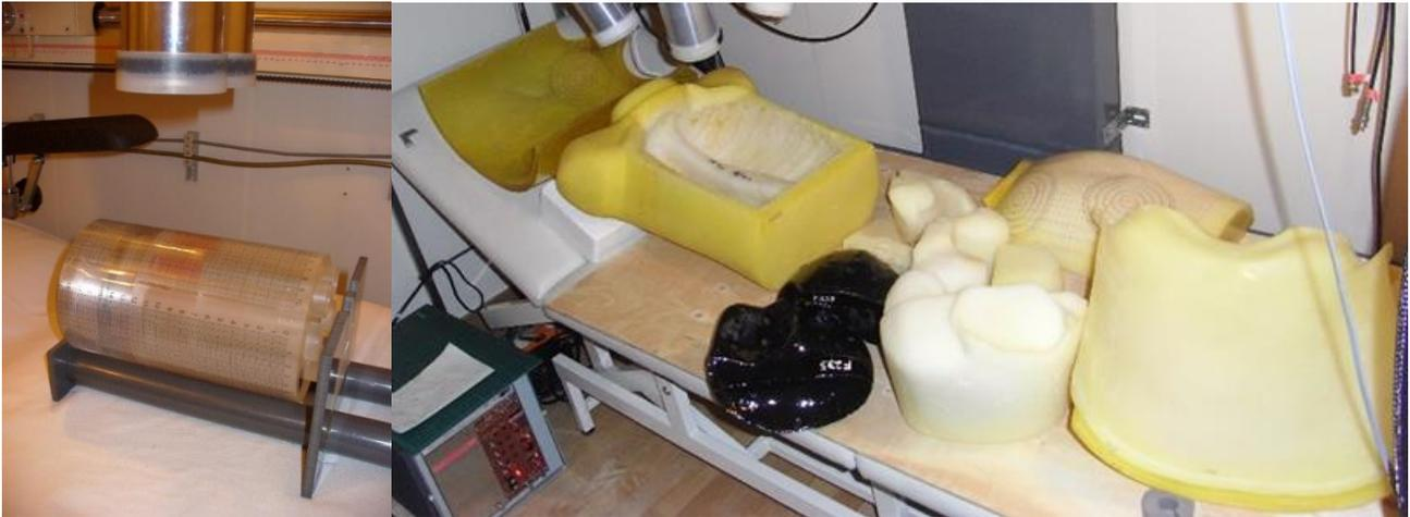
**Abbildung 5: Zwei Kalibrier-Phantome für den Teilkörperzähler. Links das Halsphantom zur Kalibrierung für Schilddrüsenmessungen, rechts das Lungenphantom mit Zubehör (Organe und Overlays zur Simulation von Personen mit verschiedenen Brustwanddicken und -typen in zerlegtem Zustand).**
