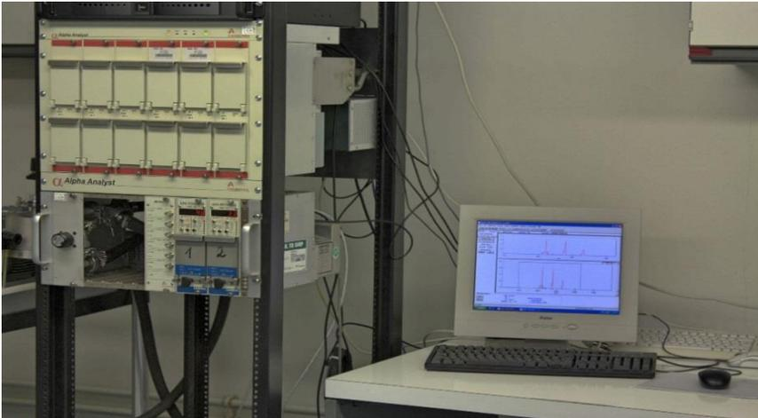
**Abbildung 6: Alpha-Spektrometer mit 12 Messkammern für die Messung von chemisch aufbereiteten Ausscheidungsproben.**
