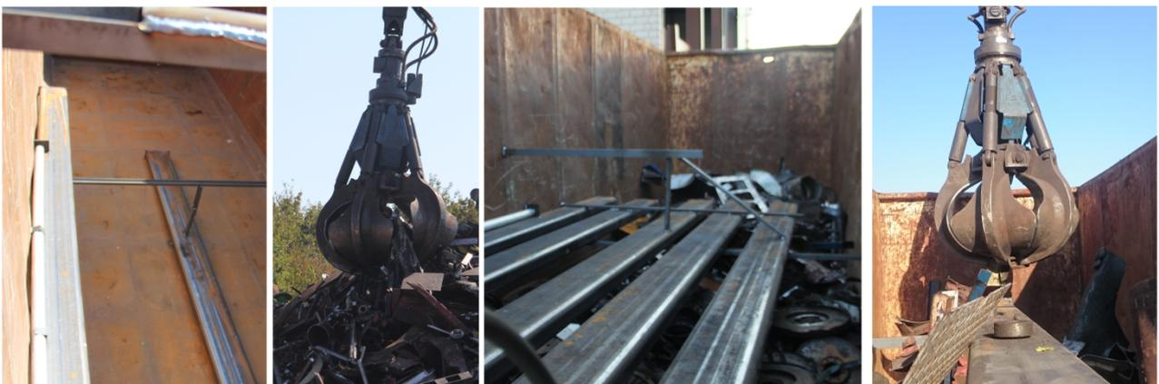
Um eine Aussage über die mittlere Dichte der Schrottladung zu bekommen wurde der LKW mit dem Container vor und nach der Beladung (inklusive Probenrohre und Gestell) gewogen. Hierbei wurden die folgenden Massen ermittelt:
