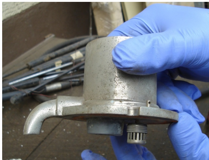
Abbildung 5-7: Abnehmbares Oberteil mit Zapfhahn für das mit Radium angereicherte Wasser und der Radium-Quelle im geschlitzten Reservoir
