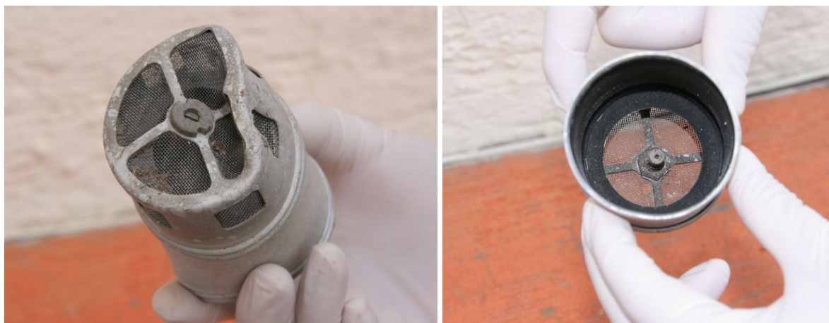
Abbildung 5-2: Außen- und Innenansicht eines der Rauchmelder mit Quelle in Korbmitte
