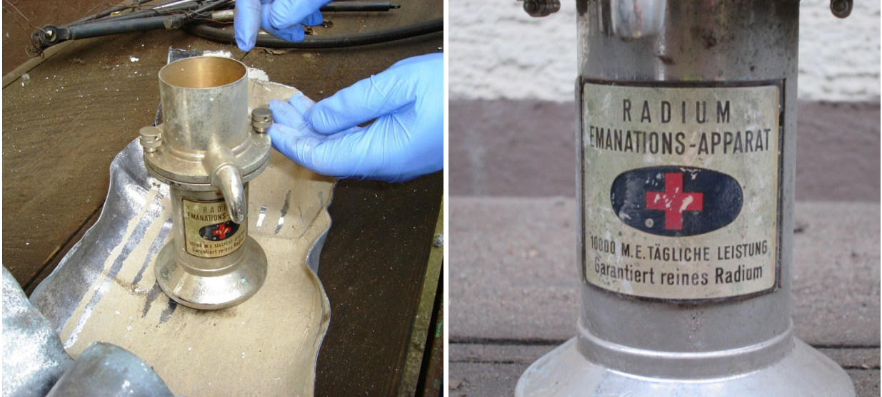
Abbildung 5-6: Radium-Emanationsapparat mit Angaben zur Aktivität
