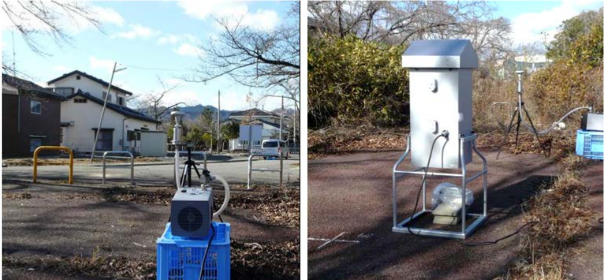
Abb. 2.8 Kaskaden-Impaktor (LPI 30, Fa. Hauke, Gmunden) für größenfraktioniertes Sammeln (links) und HiVol-Filtersammler (rechts im Vordergrund) zum Sammeln des Gesamtstaubes am Rand einer Wohnsiedlung.
