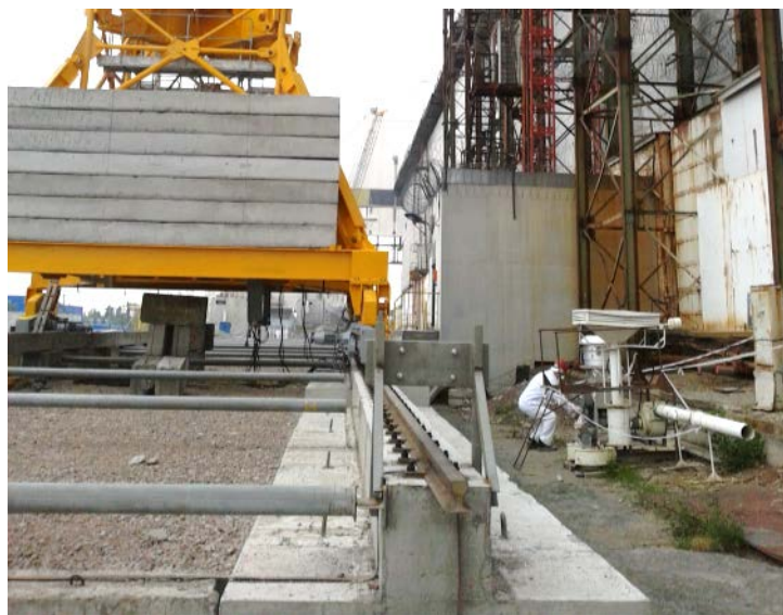
Abb. 2.3 Filterwechsel bei den Aerosolsammelgeräten am Tschernobyl KKW.
