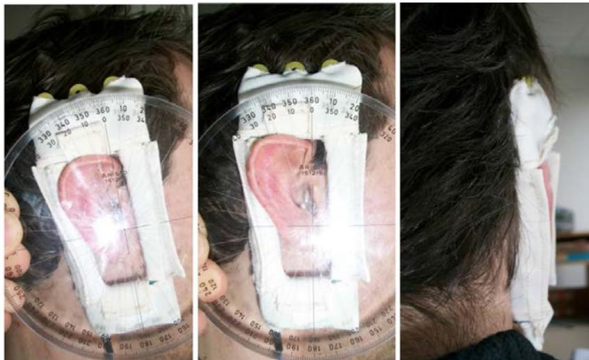
**Abb. VI.4: Erhebung der Variationsbereiche charakteristischer geometrischer Parameter zur Abschätzung der Unsicherheiten zufolge von geringfügigen Schwankungen der Antennenposition.**
