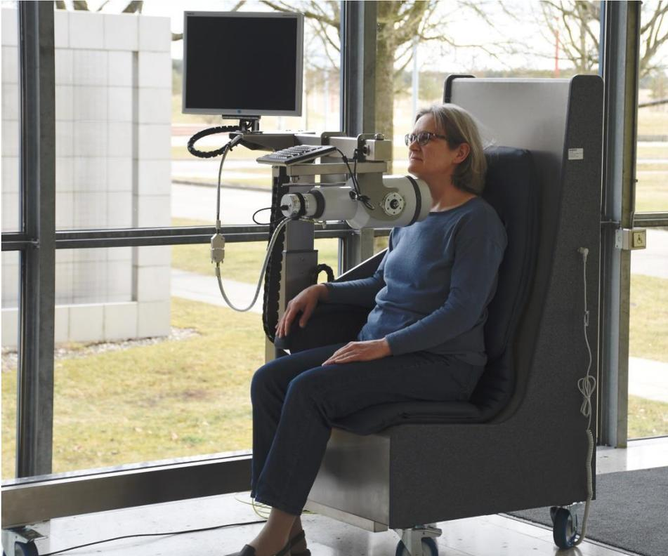
**Abb. 10: Der neue Schilddrüsen-Messplatz mit Szintillationsdetektor, Shadow-Shield-Abschirmung (Ringkollimator und abgeschirmte Rückenlehne) und Auswerte-Computer.**
