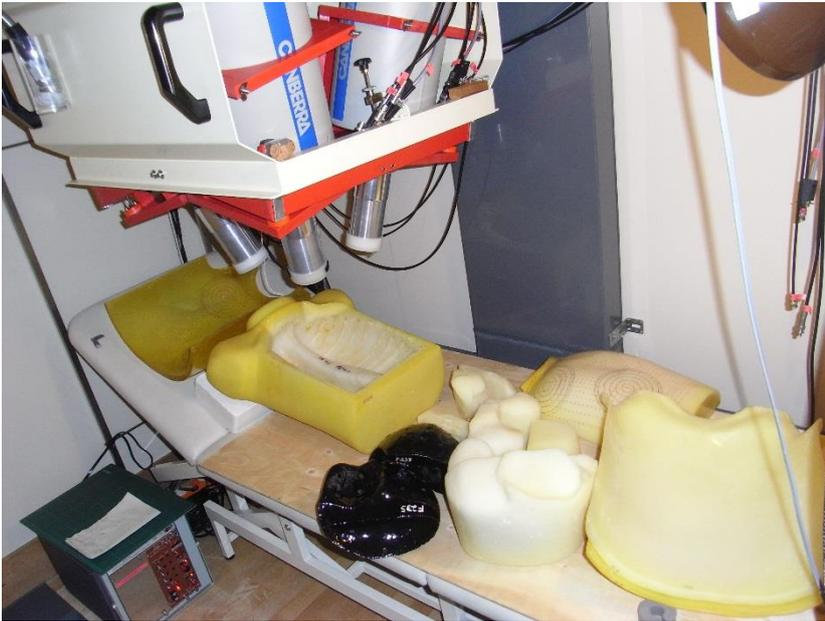
**Abb. 8:** Der Lungenzähler Neuhberg. Zu sehen sind drei der vier Reinstgermaniumdetektoren und die angeflanschten Dewar-Gefäße für den Flüssigstickstoff. Auf der Messliege befindet sich das LLNL-Lungenphantom (mit Organen und Overlays in zerlegtem Zustand).
