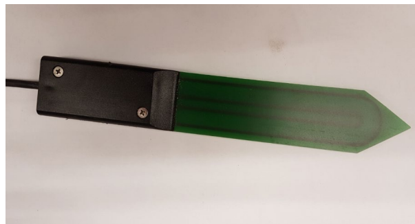
Abbildung 3: Feuchtigkeits- und Temperatursensor, der Hochkant in die Säule eingebaut wird
