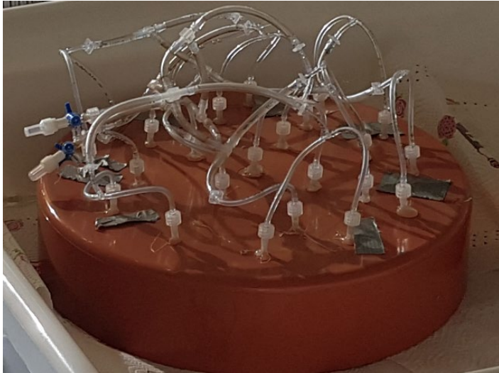
Abbildung 7: Deckel mit Berieselungspunkten
