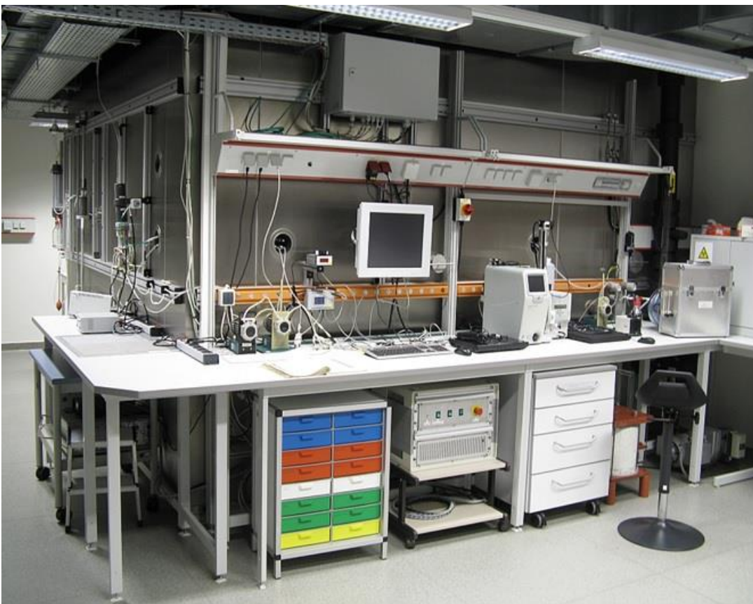
Abbildung 3-1: Kalibrierlaboratorium für Radonmessgeräte des Bundesamtes für Strahlenschutz mit Kalibrierkammer (Volumen: 30 m 3 ) / Figure 3-1: Radon Calibration Laboratory of the Federal Office for Radiation Protection with calibration chamber (volume: 30 m 3 )
