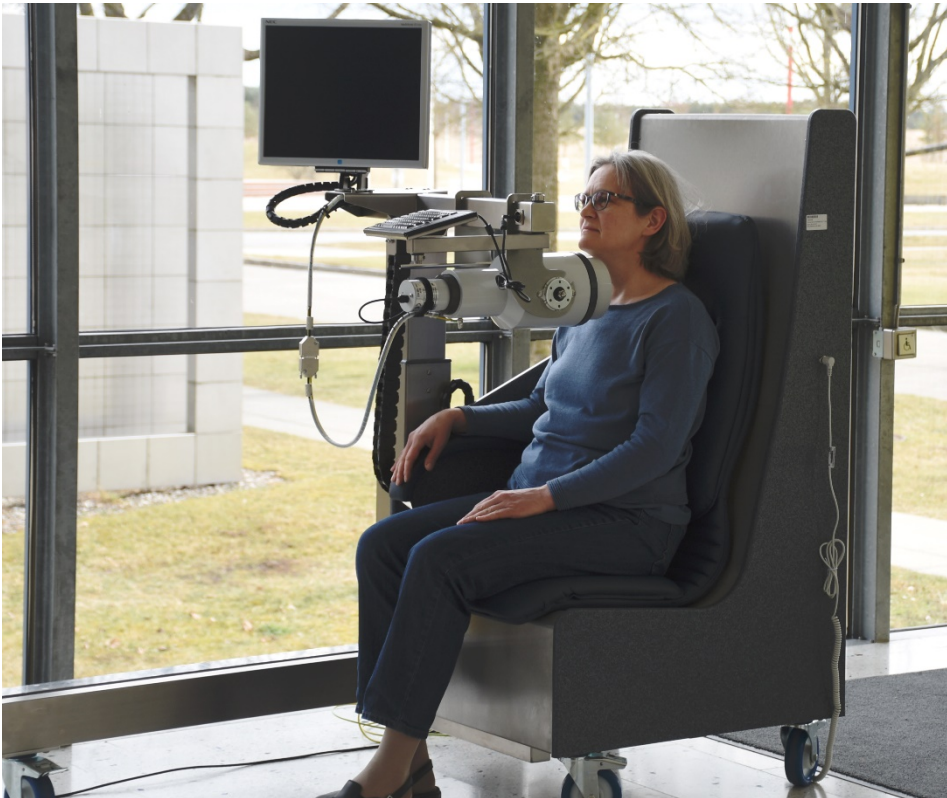
10 Der neue Schilddrüsen-Messplatz mit Szintillationsdetektor, Shadow-Shield-Abschirmung (Ringkollimator und abgeschirmte Rückenlehne) und Auswerte-Computer.
