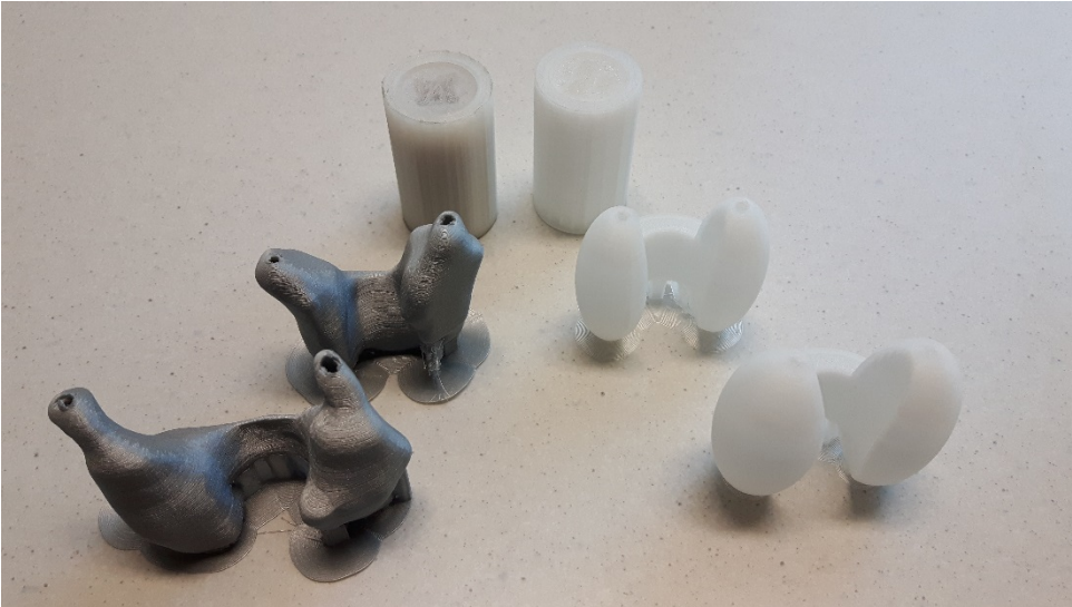
11 Gedruckte Schilddrüsenquellen, links vorne: anatomische Schilddrüsen männlich und weiblich, hinten: zylinderförmige Schilddrüsen, rechts vorne: geometrisch komplexere „experimentelle“ Schilddrüsen in zwei unterschiedlichen Größen.
