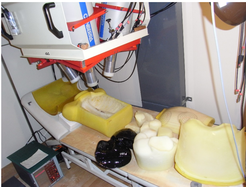
8 Der Lungenzähler. Zu sehen sind drei der vier Reinstgermaniumdetektoren und die angeflanschten Dewar-Gefäße für den Flüssigstickstoff. Auf der Messliege befindet sich das LLNL-Lungenphantom (mit Organen und Overlays in zerlegtem Zustand).
