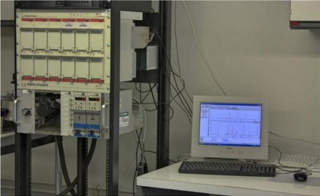
9 Alphaspektrometrie-Messplatz. Zu sehen sind das Alphaspektrometer mit 12 Messkammern und der Auswerterechner.
