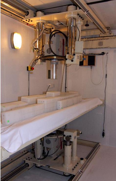
5 Ganzkörperzähler mit Kalibrierphantom (70-kg-Konfiguration).
