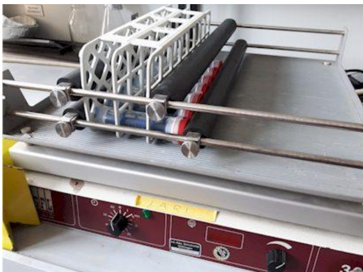
Abb. 24: Homogenisierung einer Hirschtrüffelprobe mit Aktivkohle in einem „Hin und Her Schüttler“. Bildquelle: LARI
