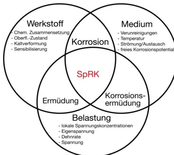
Bild 5 : Korrosionssystem Werkstoff-Medium-Spannung und Einflussfaktoren
