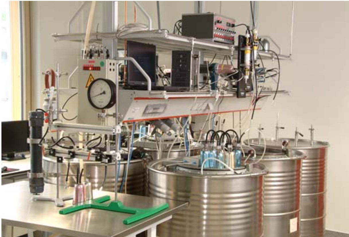
Abbildung 2.1 Im BfS-Radonkalibrierlabor bieten verschiedene Behälter die Möglichkeit, Kalibrieratmosphären unterschiedlicher Radonaktivitätskonzentration bereit zu stellen.
