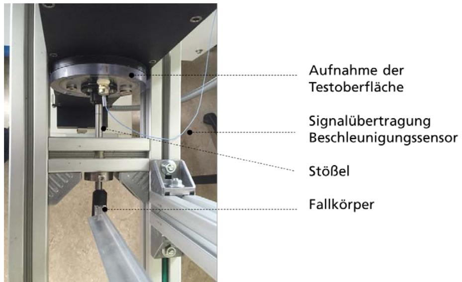
**Abb. 3-2:** Details der Apparatur.
