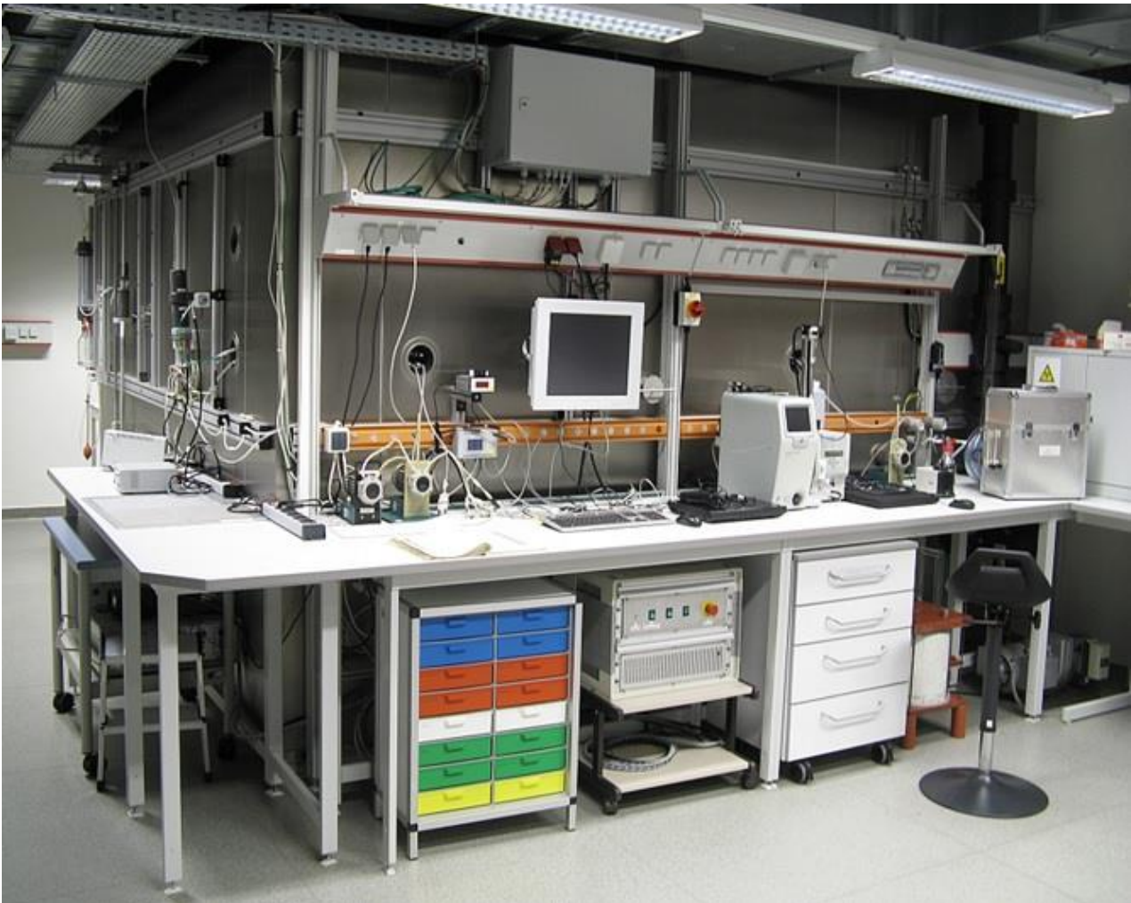
Abbildung 3-1: Kalibrierkammer im Radon-Kalibrierlaboratorium des Bundesamts für Strahlenschutz (Volumen: 30 m 3 ) / Figure 3-1: Calibration chamber in the Radon Calibration Laboratory of the Federal Office for Radiation Protection (volume: 30 m 3 )
