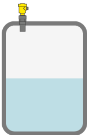
Abbildung 8: Füllstandsmessung mit Radar
