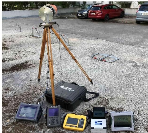
Bild 3.3.1: Lage des Messpunktes in Relation zur Basisstation (links) und Aufbau der Messantenne auf dem Stativ mit den untersuchten Messgeräten (rechts)
