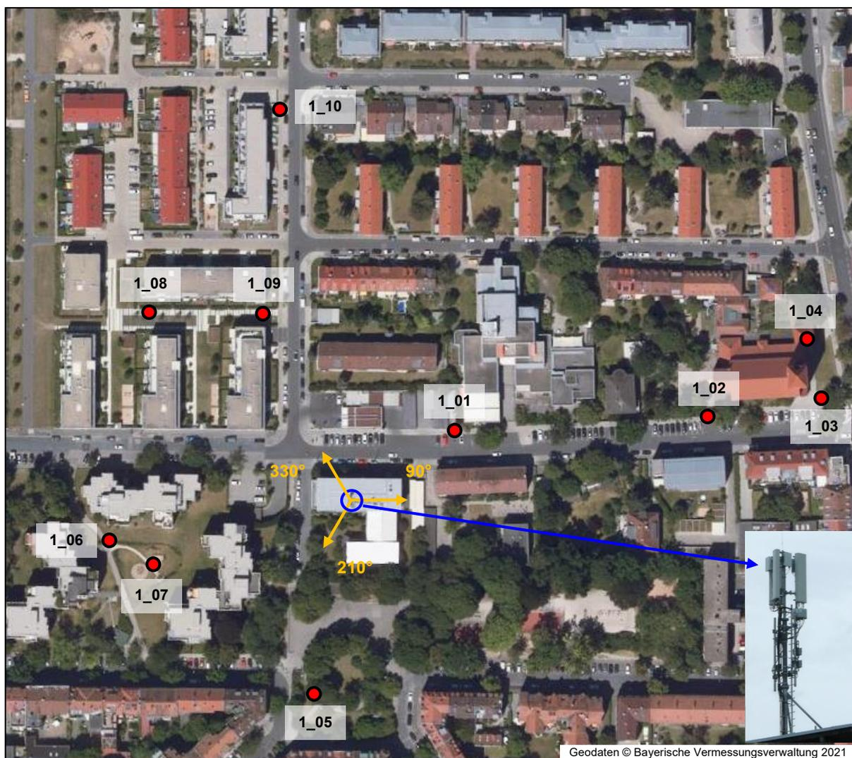
Bild 4.5.1: Standort 1: Lageplan mit Anlagenstandort, horizontale Ausrichtung der 5G-Sendeantennen und Verteilung der Messpunkte
