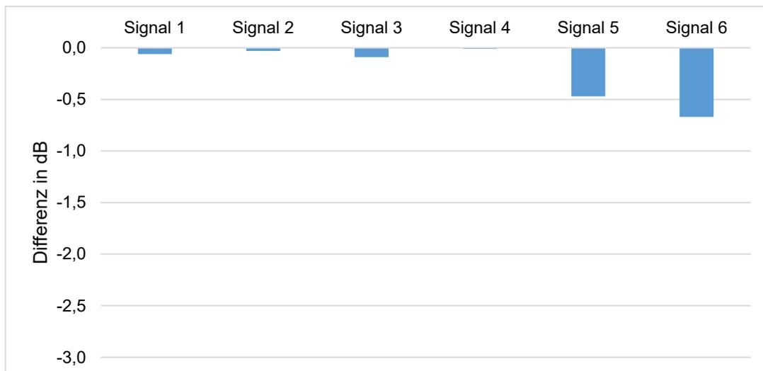
Bild 3.1.5: Messung der zeitlich gemittelten Momentanimmission: Differenz zwischen thermischer Messung (NRVD) und Messung mit dem SRM-3006 nach dem vorgeschlagenen Verfahren (Average-Anzeige, RBW = 20 kHz) für die verschiedenen Eingangssignale.
