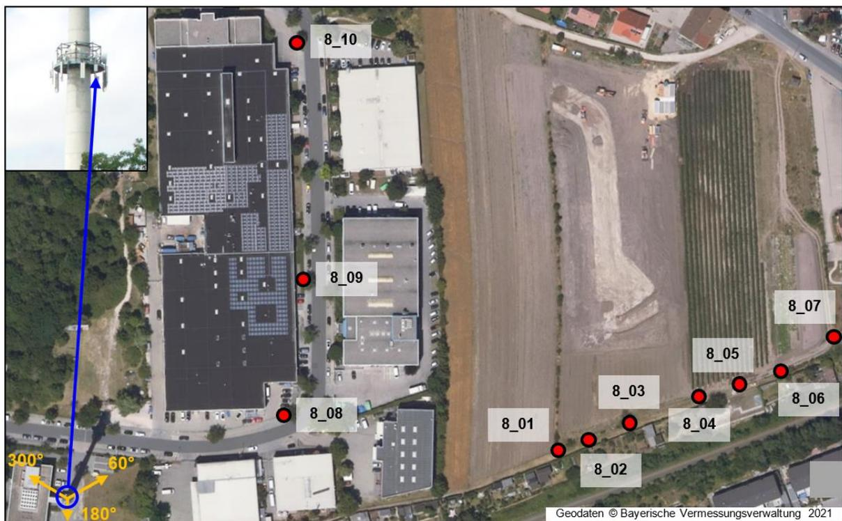
Bild 4.5.9: Standort 8: Lageplan mit Anlagenstandort, horizontale Ausrichtung der 5G-Sendeantennen und Verteilung der Messpunkte
