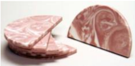
12 (BR3D model 020 der Firma CIRS. Links: Darstellung der Verwirbelungen. Rechts: Schematische Darstellung der Strukturverteilung.)
