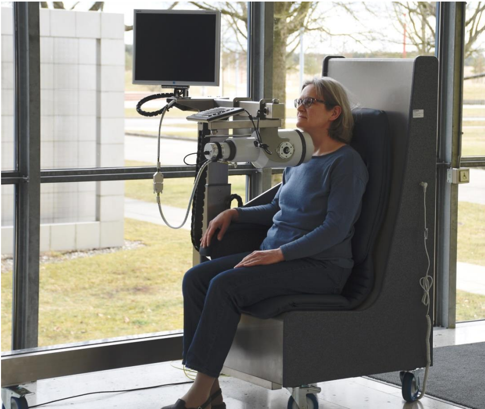
9 Der neue Schilddrüsen-Messplatz mit Szintillationsdetektor, Shadow-Shield-Abschirmung (Ringkollimator und abgeschirmte Rückenlehne) und Auswerte-Computer.
