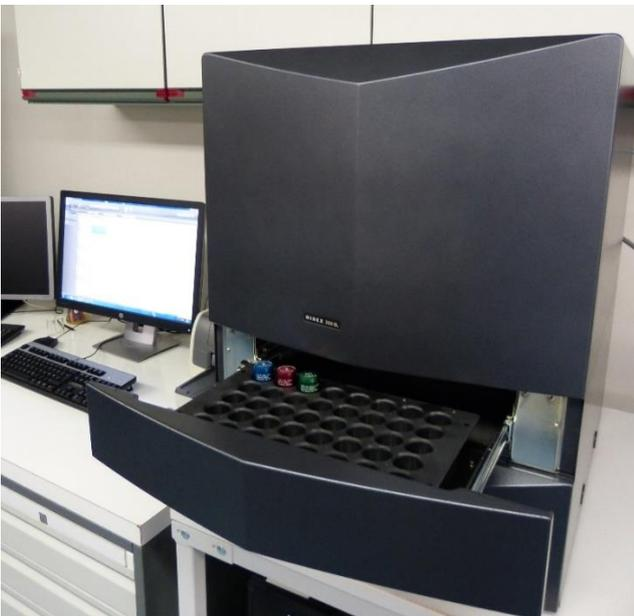
10 Flüssigszintillationsspektrometer Hidex 300 SL und Auswerterechner. In der geöffneten Probenkammer stehen die zertifizierten Standards für die Qualitätssicherung.
