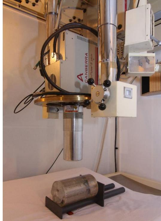
6 Ganzkörperzähler. Detektor über dem Halsphantom zur Schilddrüsenkalibrierung.
