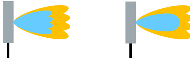
Abbildung 2-6 Unterschiedliche Abstrahlungseigenschaften von SSBs (blau) und Datenübertragung (gelb). Links: gleiche Form der Einhüllenden, rechts: unterschiedliche Form der Einhüllenden [29]
