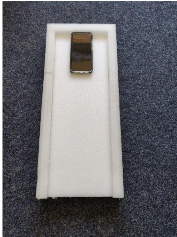
Abbildung 3-36 Schaumstoffunterlage zum Halten des Smartphones bei den Messungen im freien Feld
