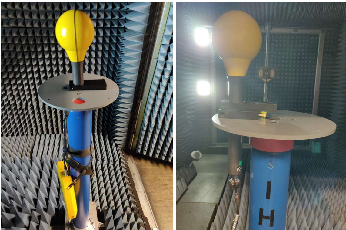
Abbildung 3-21 In Messkammer montierte Messsonde zur Ermittlung der elektrischen Feldstärke am Messort der Smartphones
