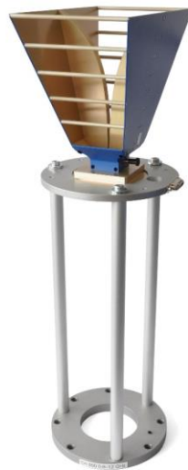
Abbildung 3-18 Für die Labormessungen verwendet Antenne SH 800 von Satimo
