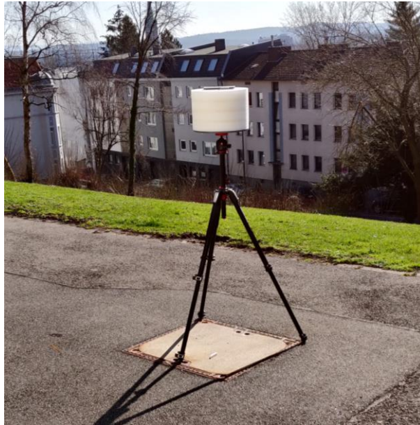
Abbildung 3-43 Für die Ausrichtungsmessungen im freien Feld verwendete Halterung auf Stativ
