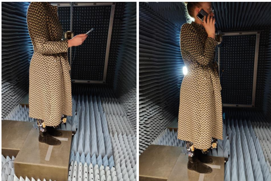
Abbildung 3-32 Nachstellung der Nutzungssituationen in der Messkammer Links: Nutzungssituation „Halten des Smartphones in der Hand zum Betrachten“ Rechts: Nutzungssituation „Smartphone zum Telefonieren am Ohr“
