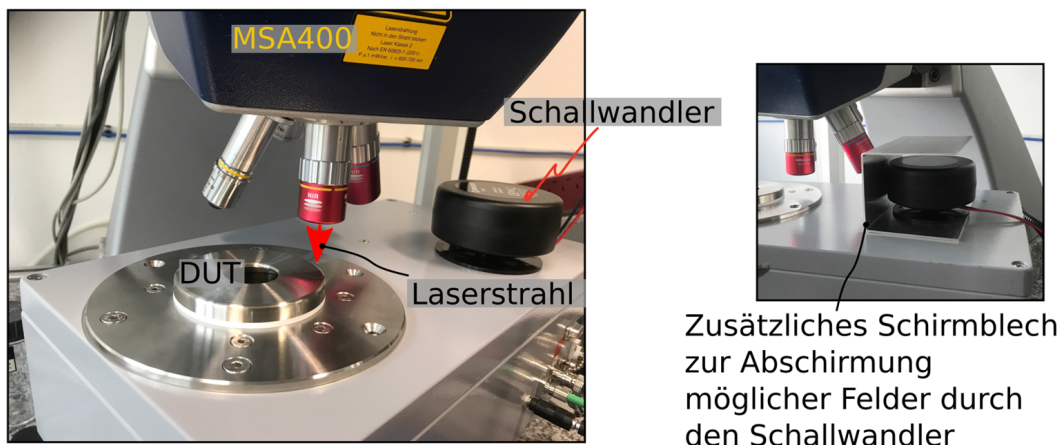
Abb. 93: Foto des realen Messaufbaus unter dem Mikrosystemanalysator. Zum Ausschluss des Einflusses möglicher störender elektrischer durch den Schallwandler wurde fallweise ein zusätzliches Schirmblech verwendet (rechts).
