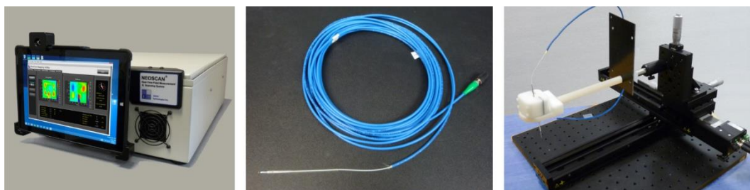
Abb. 24: NeoScan Messsystem von EmagTech. Rechts eine Detailansicht des EO-Aufnehmers [EMAG2020].
