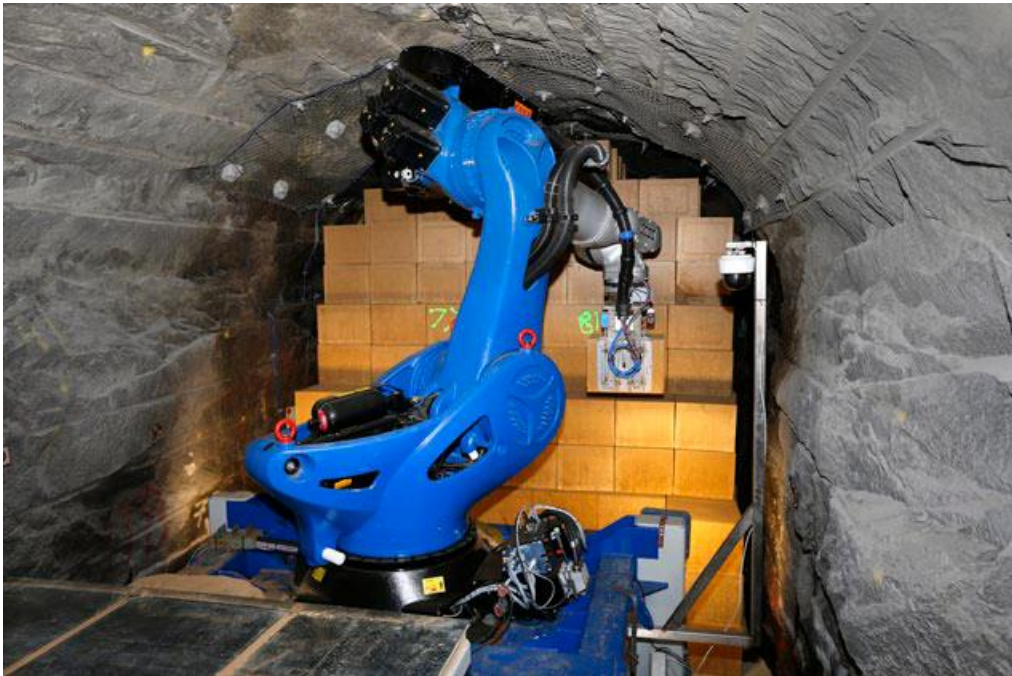
Abbildung 56: Prototyp-Roboter für den Einbau von Bentonit-Blöcken in der Einlagerungsstrecke (SKB - Swedish Nuclear Fuel and Waste Management Company, 2016)
