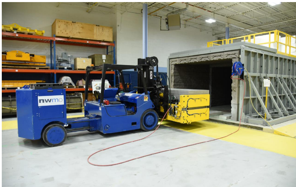
Abbildung 55: Prototyp der Einlagerungstechnik und Mock-up Full-scale Einlagerungsstrecke
