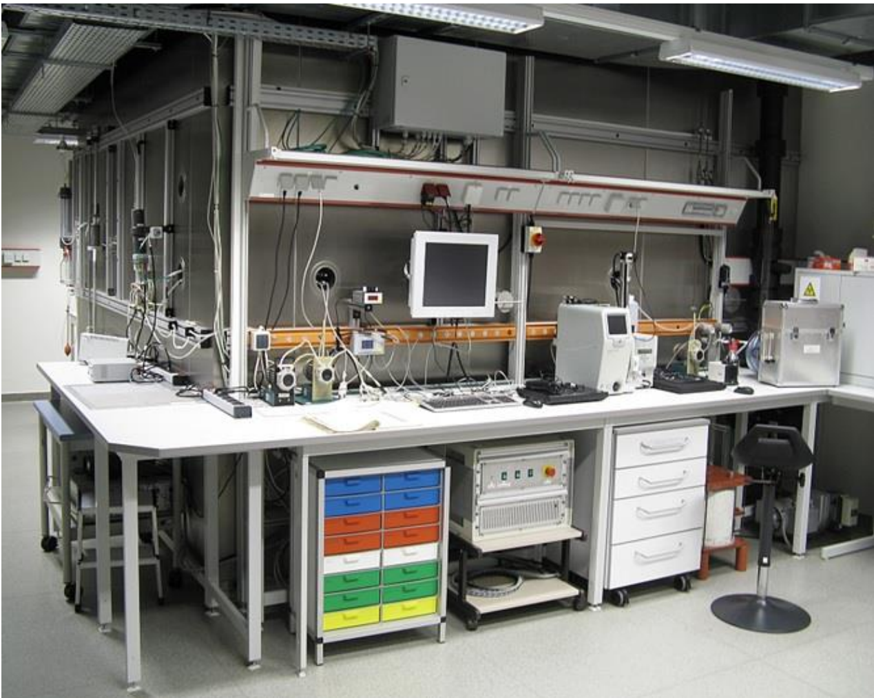
Abbildung 3-1: Kalibrierkammer im Radon-Kalibrierlaboratorium des Bundesamtes für Strahlenschutz (Volumen: 30 m 3 ) / Figure 3-1: Calibration chamber in the Radon Calibration Laboratory of the Federal Office for Radiation Protection (volume: 30 m 3 )
