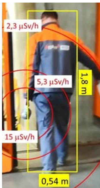
Abbildung 1: Graphische Darstellung der Dosisleistung für Ir-192 (1225 GBq, rote Linien), projiziert auf die Körperkontur eines Prüfers beim Tragen des Geräts
