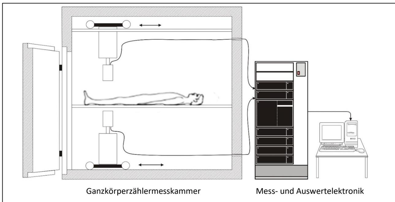
4 Schematischer Aufbau der Ganzkörpermessanlage
