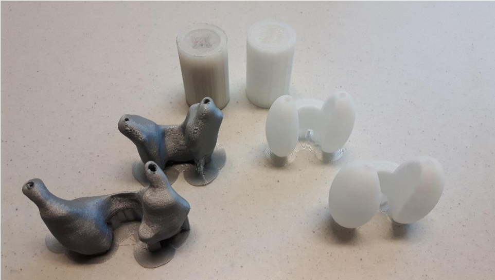
10 Gedruckte Schilddrüsenquellen, links vorne: anatomische Schilddrüsen männlich und weiblich, hinten: zylinderförmige Schilddrüsen, rechts vorne: geometrisch komplexere „experimentelle“ Schilddrüsen in zwei unterschiedlichen Größen.
