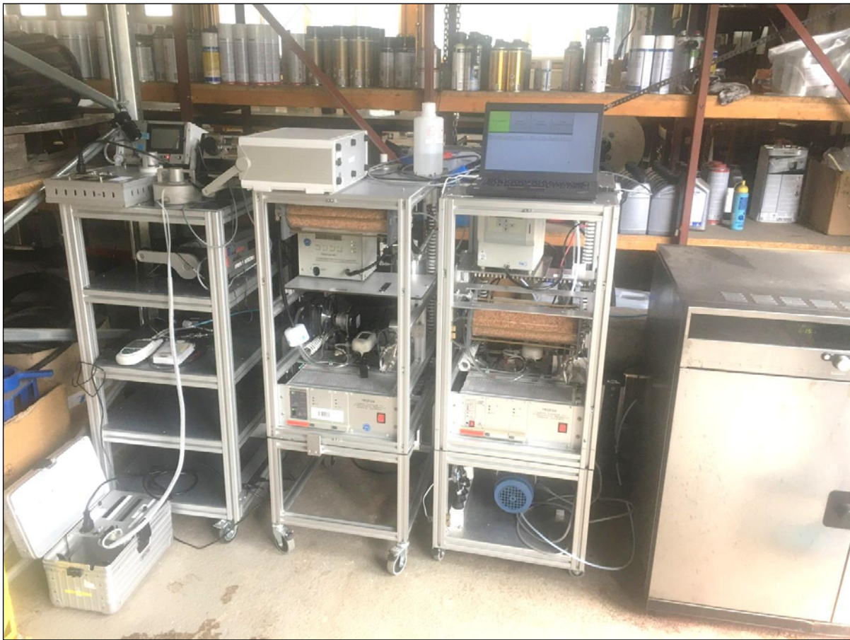
Abbildung 2: Messanordnung verschiedener Messgeräte für Radon, Radonfolgeprodukte und weitere Parameter
