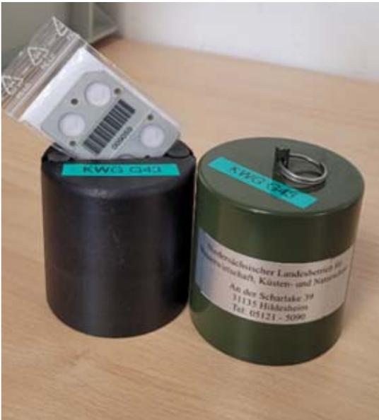
Abb. 1:  $H^*(10)$  Umgebungsdosimeter der Auswertestelle
