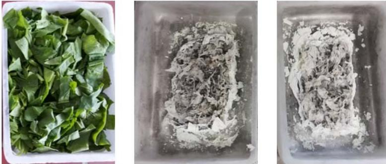
Abb. 2: links: grob zerkleinerte Spinatprobe, Spinatasche nach einer Veraschungszeit von Mitte: einer Stunde, rechts: drei Stunden, jeweils bei 600 °C.
