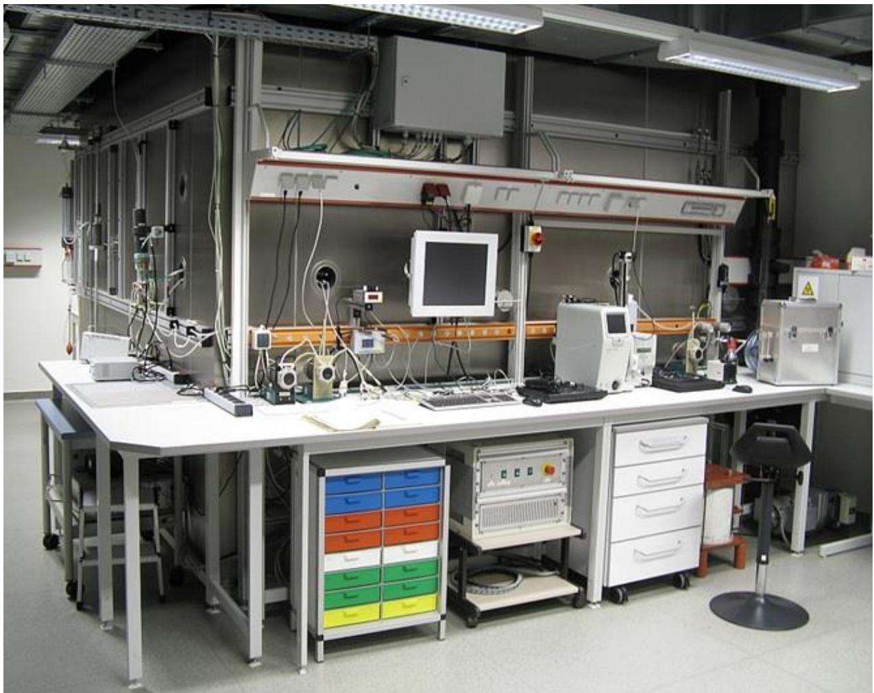
Abbildung 3-1: Kalibrierkammer im Radon-Kalibrierlaboratorium des Bundesamtes für Strahlenschutz (Volumen: 30 m<sup>3</sup>) / Figure 3-1: Calibration chamber in the Radon Calibration Laboratory of the Federal Office for Radiation Protection (volume: 30 m<sup>3</sup>)
