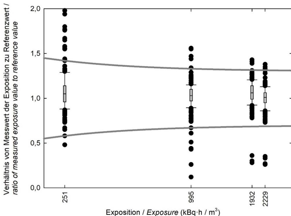
Abbildung 4-5 Abweichung der Messwerte der 43 Messgeräte-Sets in den vier Expositionsgruppen von den jeweiligen Referenzwerten (als Verhältnis) und erlaubter Bereich. / Figure 4-5 Deviation of the measurement values of 43 sets of measurement instruments in 4 exposure groups from the respective reference value (ratio) and region of acceptance.
